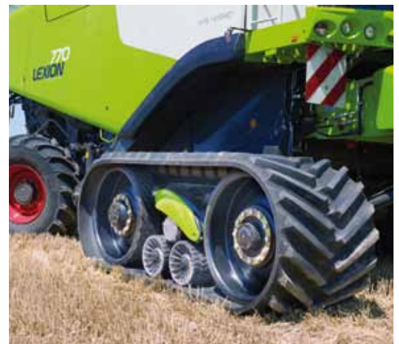
Breite Schneidwerke, größere Korntanks, hohe Eigengewichte und die StVO befördern die Raupenlaufwerke zur Bodenschonung.
