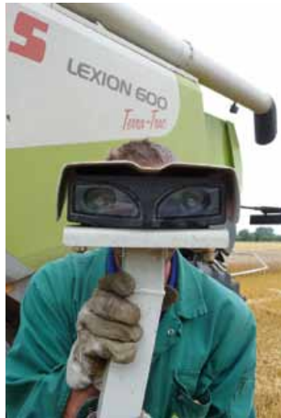
Lenkhilfen erhöhen die Mähdrescherleistung um mindestens 10 Prozent.
