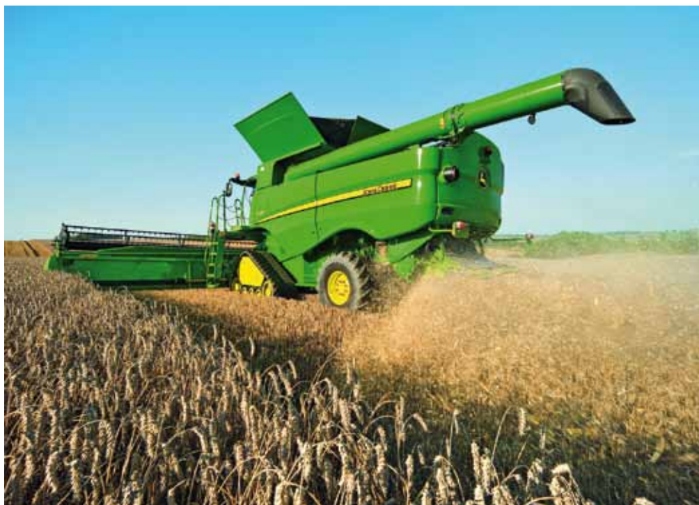
Eine aktive Strohverteilung muss auch bei größeren Arbeitsbreiten eine windstabile Verteilung gewährleisten.
