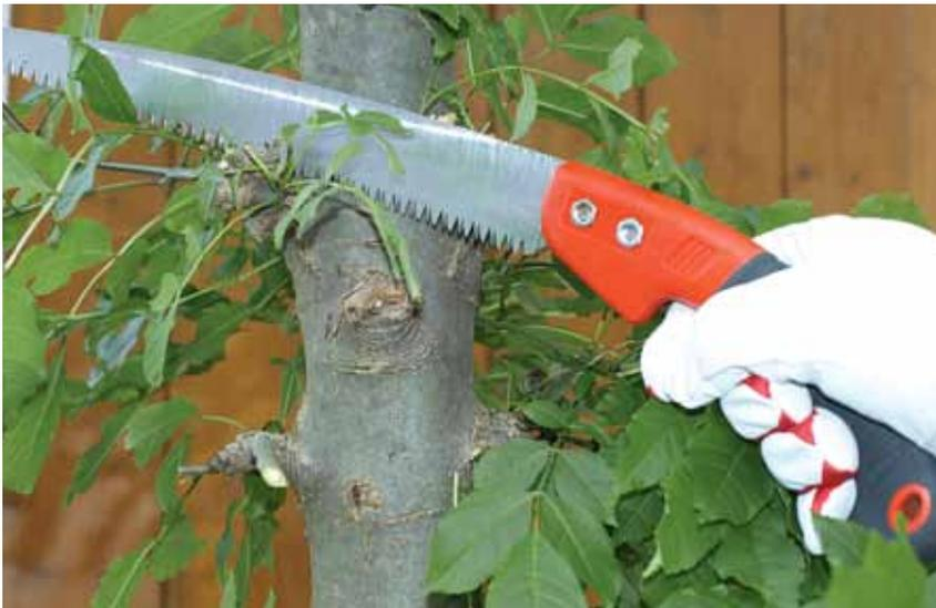
*Handsägen sollten scharf sein, damit sie ihren Zweck erfüllen und keine zu großen Wunden hinterlassen. Für die Waldpflege ist die Dreiecks- oder Wolfsbezaehlung geeignet. Ein Freiwinkel am Ende des Zahnes sorgt dafür, dass die Säge im Holz greift.*
