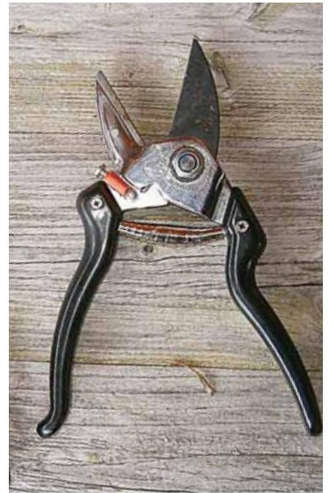
Eine Bypass-Schere – die Klingen gleiten beim Schneiden aneinander vorbei. Sie erzeugt vor allem in frischem Holz einen glatten Schnitt, bei trockenen Ästen ist die Ambosshandschere besser geeignet.
