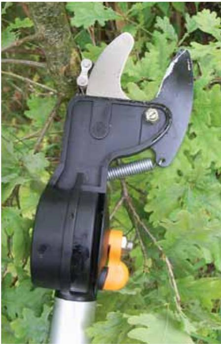
Die Baumgiraffe, eine Schere mit Hebelübersetzung kann auch stärkere Äste in größerer Höhe schneiden. Mit einem Gestänge versehen wird der Schnitt per Schnurzug betätigt.
