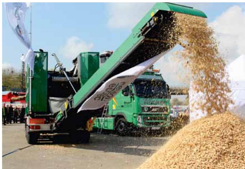
**Mit dem CH 1266 von Neuson ecotec lassen sich Hackschnitzel unterschiedlichster Größe produzieren. Eine Besonderheit liegt darin, die Klängen des Rotors zu wechseln: Biomasserotor für verschmutzte Materialien und Messerrotor für die saubere Hackschnitzelproduktion.**
