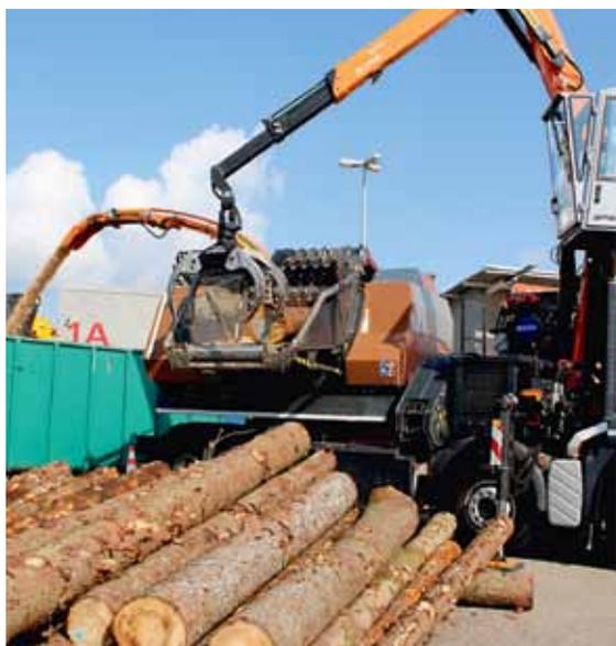
**Der DW 3060 von Doppstadt zerkleinert mit einer direktangetriebenen Walze verschiedenste Materialien. Ein hydraulisch gesteuertes Gegenkamm schützt die Maschine.**
