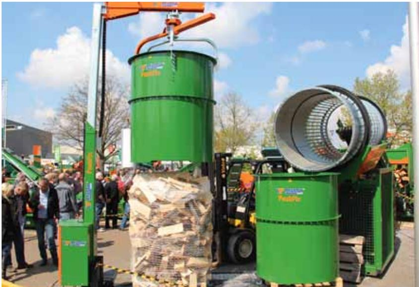
Die Trommeln des PackFix Hydro mobil stehen auf Paletten, werden befüllt, und dann von unten nach oben mit einem Netz bezogen, in das 1,6 m oder 1 m Scheite passen.
