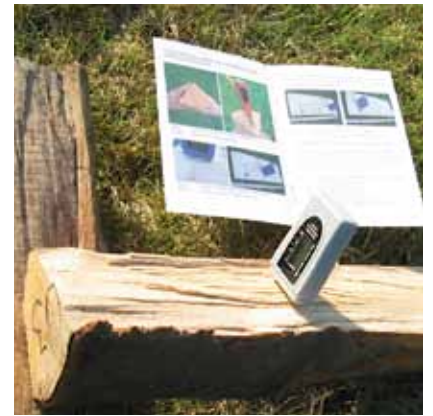
Mit der „IBT-Richtlinie zur Messung und Bestimmung der Brennholzfeuchte“ und einem handelsüblichen elektrischen Widerstandsmessgerät kann die Holzfeuchte von luftgetrocknetem Brennholz einfach und hinreichend genau bestimmt werden.
