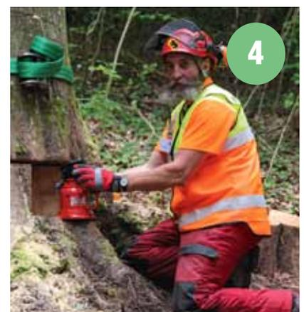
Fällheber wird nach hinten geschoben und positioniert...
