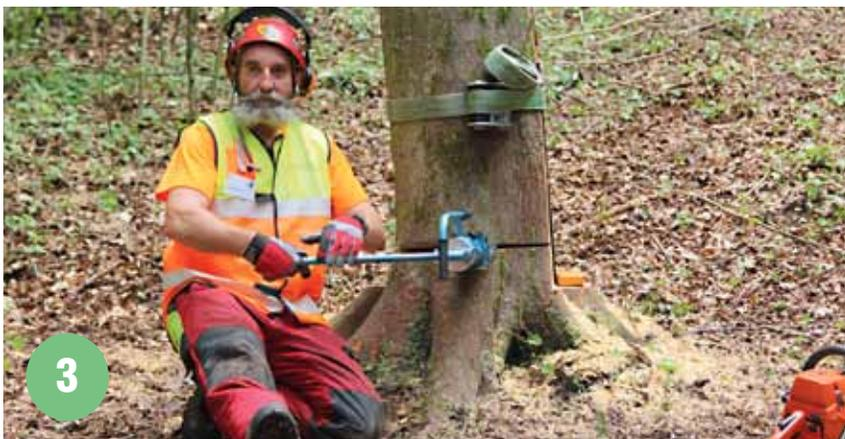
*Der Pumphebel des Fällkeils ist rechts oder links montierbar, sodass jeder eine geeignete Stellung finden wird, um den Keil bis zu 50 mm hoch zu treiben.*
