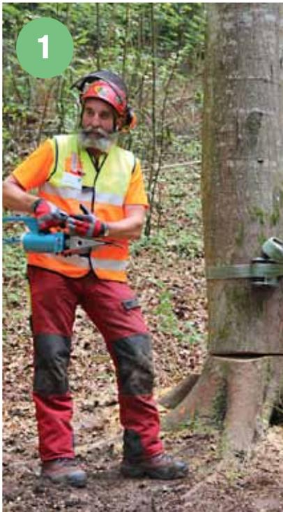
*Auch der hydraulische Fällkeil hat ein Gewicht von 10 kg. Er kann auch bei kleineren Durchmesser messern angewandt werden.*
