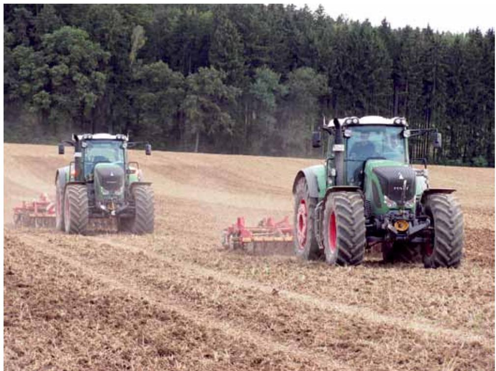
**Beim Guide-Connect-System von Fendt folgt ein unbemannter Traktor spurversetzt einem Führungsfahrzeug mit Fahrer.**
