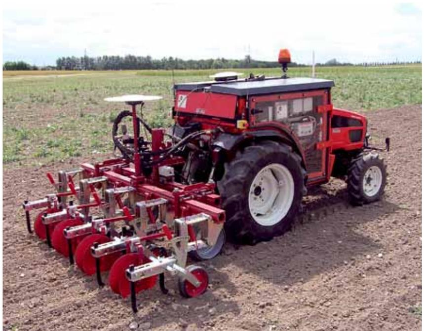
Kein Platz mehr für einen Fahrer: Der autonome AMS-Traktor von Hako (AMS=Autonomous Mechanisation System).
