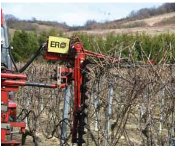
Winterschnitt beim Minimalschnitt im Spalier mit einem Balkenmesser-Laubschneider. Fotos: Walg
