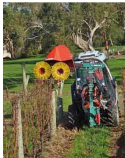
Neuer Rebholzzieher Kobold der Firma Clemens/Wagner Pflanzen-Technik.
