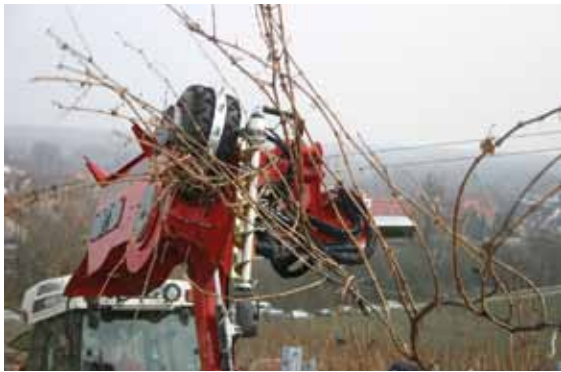
Das Rebholz wird von der Einzugvorrichtung ergriffen und der Häckslerwelle zugeführt.
