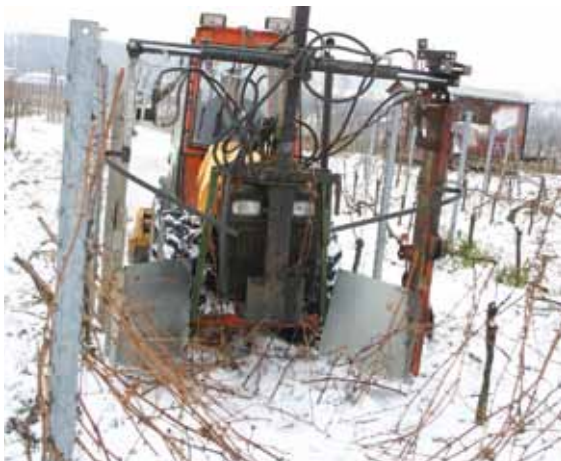
Mit einem umgebauten, zweiseitigen Laubschneider werden die in die Gasse ragenden Triebteile abgeschnitten.
