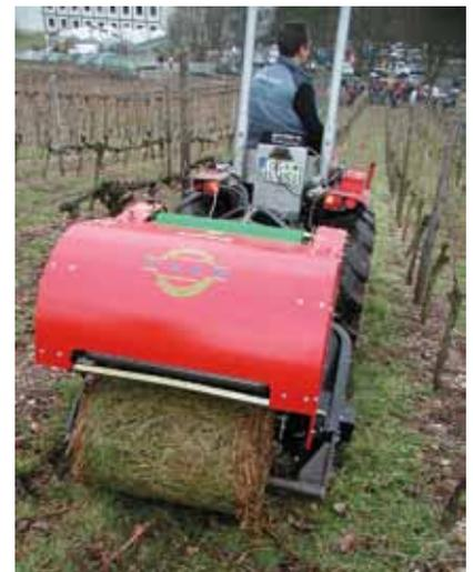
Rebholzrundballenpresse der Firma CAEB beim Auswurf eines Rebholz-Rundballens.
