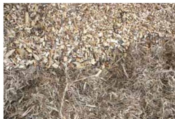
Vergleich der Aufbereitungform und der Beschaffenheit von Holzhäckselgut, oben Waldhackschnitzel (Zerkleinerung durch schneidende Werkzeuge), unten Rebholzschnitzel (Zerkleinerung durch Brechen und Zertrümmern mit Schlegelhäcksler = Schreddergut)
