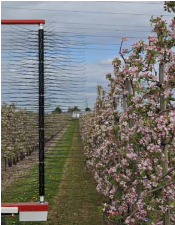
Darwin Gerät kurz vor dem Einsatz in einer Pinova-Fruchtwand
