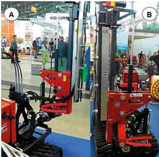
Abb. 5: Multifunktionsarm der Firma Niko – Neigungswinkel, Höhe, Parallelverschiebung sowie Dreheinrichtung (180°) von Anbaugeräten einstellbar. A) Rückansicht; B) Frontansicht.
