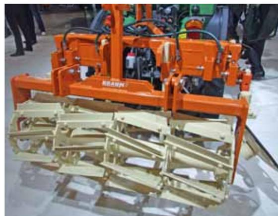
Abb. 2: Mulchwalze „Acti-Roll“ der Firma Braun – durch die offene Bauweise sollen weniger Verstopfungen des Begrünungsaufwuchses entstehen. Fotos: Petgen
