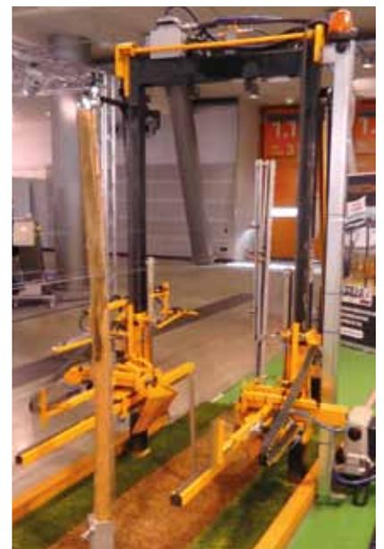
Abb. 4: Die Heftmaschine „Basilia“ der Firma Vignetinox nimmt die Drähte auf und legt sie in die Heftstationen ab.
