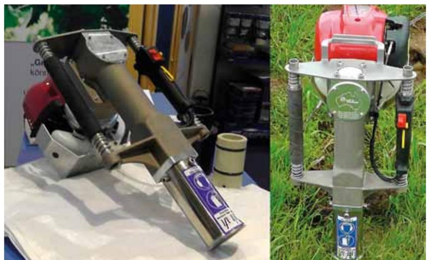
Abb. 11: Der Gripple Petrol Driver der Firma Gripple als motorisierte „Ramme“ im Einsatz in Neuanlagen sowie bei Ausbesserungsarbeiten
