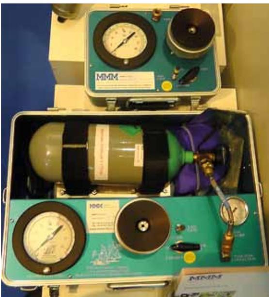
Abb. 6: Scholanderkammern der Firma Mosler – geeignet zur Untersuchung von Trockenstress in der Rebanlage. Oben: M-600 – Unten: M-615 mit integrierter Druckflasche.
