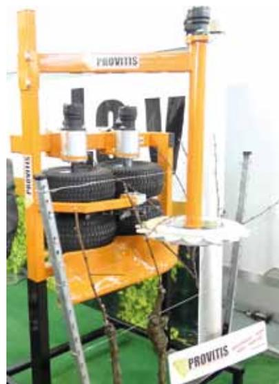
Abb. 9: Am Stand der französischen Firma Provitis wurde ein neues Gerät zum seitlichen Herausziehen des Rebholzes vorgestellt.
