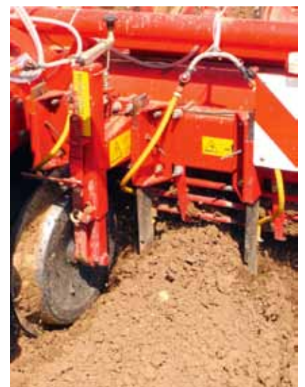
Die Düngerapplikation beim Dammerfräsen durch Applikationsschare.
