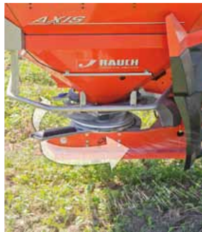
Die automatische Streubildeinstellung für Zweischiebendüngestreuer Axmat.
