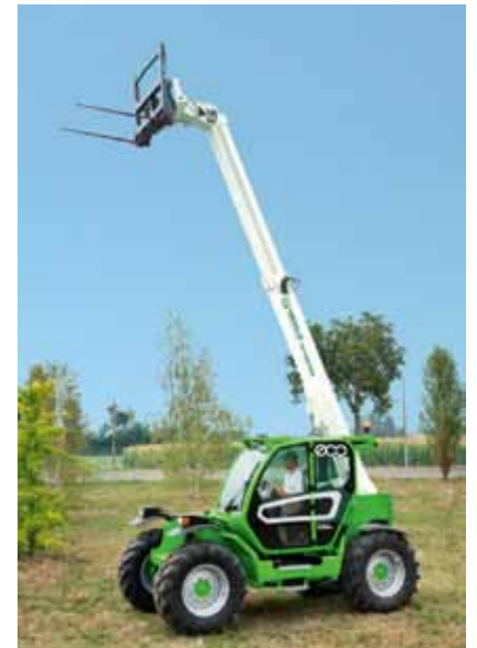
Bei Merlo Hybrid Teleskopplader erfolgt der Antrieb wahlweise elektrisch oder diesel-elektrisch.
