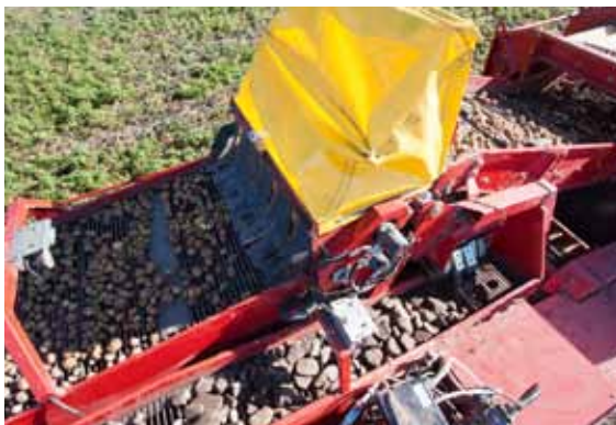
Das pneumatische Beimengungstrenngerät AirSep von Grimme. Werkfotos
