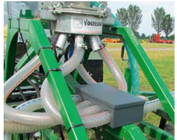
Flow-Check von Josef Kotte Landtechnik zur kontrollierten Gülleausbringung.
