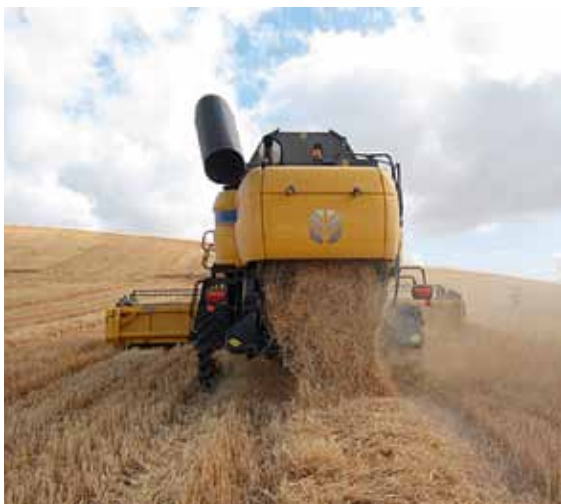
Opti Speed von New Holland CNH sorgt für variable Schüttlerdrehzahlen.
