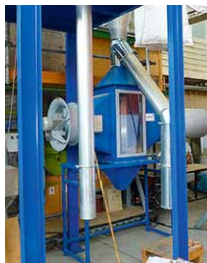
Konzentrischer Zick-Zack-Sichter zur Reinigung von Körnerfrüchten (Ambros).
