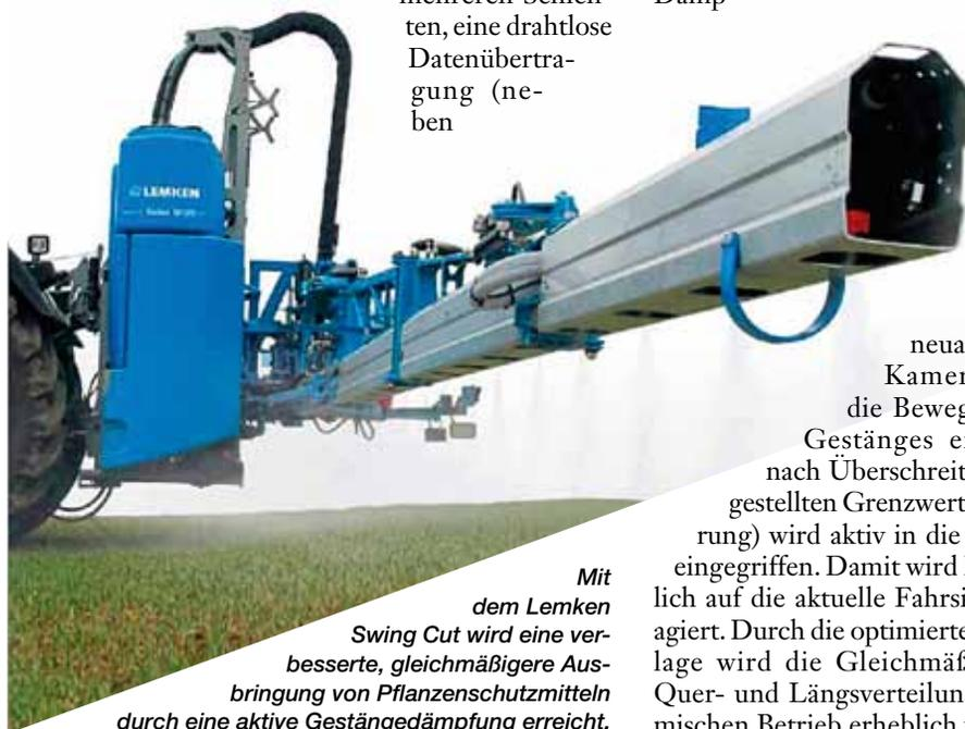
Mit dem Lemken Swing Cut wird eine verbesserte, gleichmäßigere Ausbringung von Pflanzenschutzmitteln durch eine aktive Gestängedämpfung erreicht.
