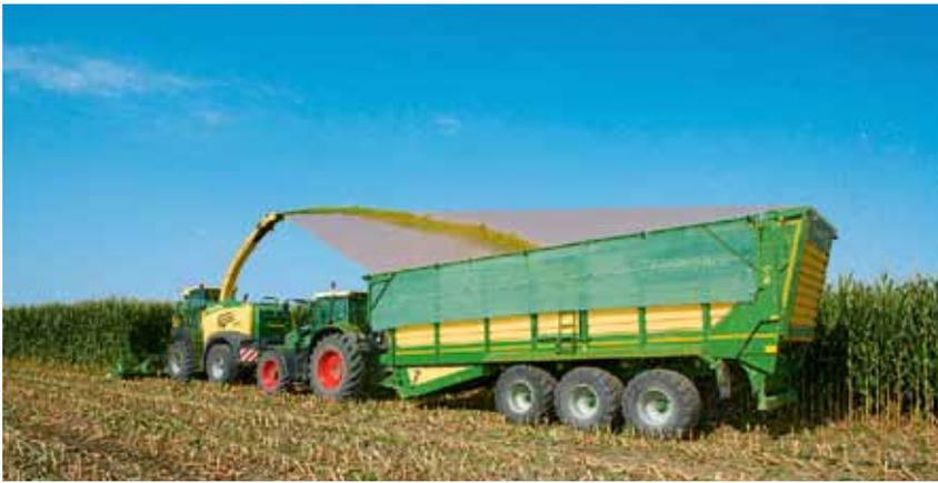
Bei der Laser-Load-Anhäcksel-Überladeautomatik von Krone erkennt ein Laserscanner das hinter dem Häcksler fahrende Gespann und steuert den Auswurfbogen.
