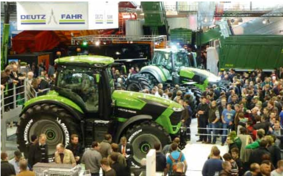
Die 11er Baureihe von Deutz-Fahr bietet neben dem stufenlosen TTV-Getriebe bis zu 440 PS.
