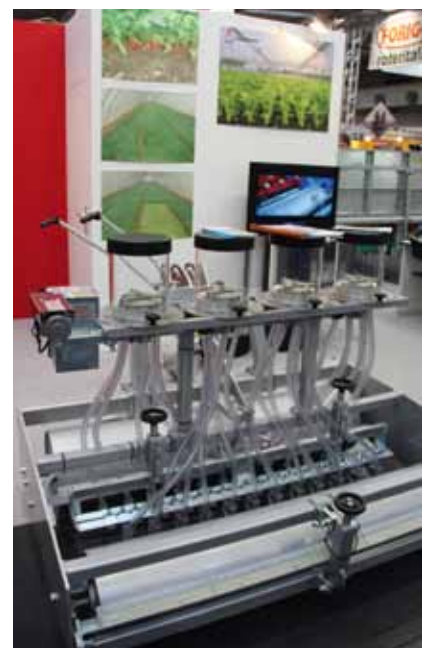
Die Sämaschine von Bassi kann sehr gleichmäßig Feldsalat, Kräuter oder Baby-leavesalate säen, die dann mit der Maschine geerntet werden. Fotos: Setzepfand
