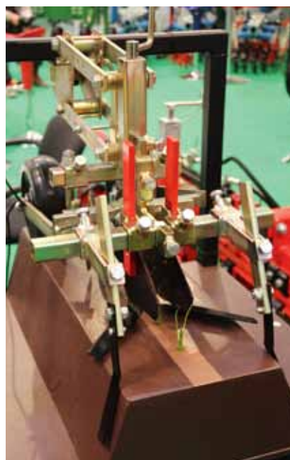
Auch die Firma KULT, Kress umweltschonende Landtechnik, aus Vaihingen widmete sich dem Thema mechanische Unkrautbekämpfung mit dem Robovator (l.), einer Coproduktion von Kress mit einer dänischen Firma. Der Robovator erkennt jede Pflanze und führt die Hacken drumherum. Auch mit der Duohacke (Mitte) wird die Kultur so nah wie möglich an das Gepflanzte sauber gehalten.
