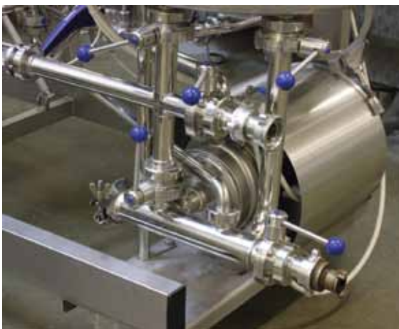
Hier ist eine Kreiselpumpe an einem Kieselgurfilter im Einsatz. Foto: Schandelmaier
