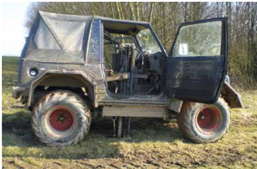
Bodenproben Jeep mit Bohrturm.
