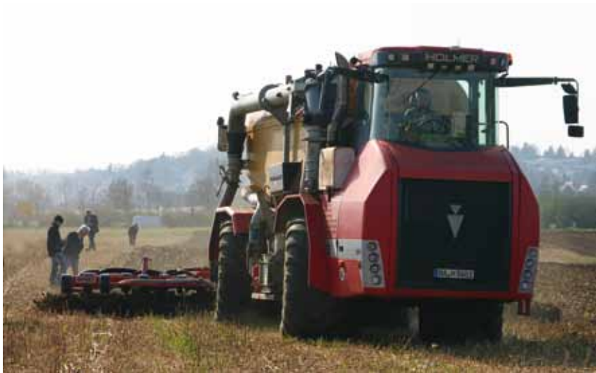
Mit dem leistungsstarken Gülleselbstfahrer Terra Variant von Holmer können immer kürzere Bearbeitungszeiträume effizient genutzt werden. Großvolumige Räder, spurversetztes Fahren, hohe Zugleistung und ein hohes Transportvolumen steigern Verfahrensleistung und Bodenschonung gleichermaßen.
