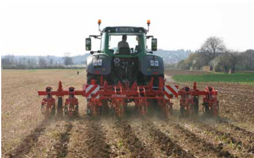
Der Kuhn Striger verbindet durch die Strip-Till-Technik schnelle Bodenerwärmung und optimale Wurzelentwicklung in den bearbeiteten Streifen mit Erosionsschutz und hoher Wasserspeicherkapazität – Zugkratteinsparung und Kostenreduzierung inklusive.
