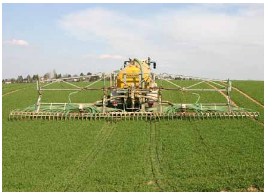
Die Zunhammer-Schleppschlauch-Verteilertechnik bietet bodennahe und nahezu geruchlose Gülleausbringung. Das Spektrum reicht von standardmäßigen 9 m bis zu immensen 33 Metern Arbeitsbreite. Der verstopfungsfrei arbeitende Verteiler mit Lochscheiben sorgt für exakte Querverteilung.
