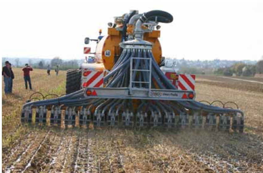
Das Schlitzgerät Eurojet 3000 von Veenhuis wurde in einer Arbeitsbreite von 6 m vorgestellt (max. 7,6 m). Das Gerät ist für große Viehhalter und Lohnunternehmer entwickelt worden. Die selbstschleifenden massiven Scheiben schneiden einen Schlitz, in den die Gülle sauber und einfach abgelegt wird.
