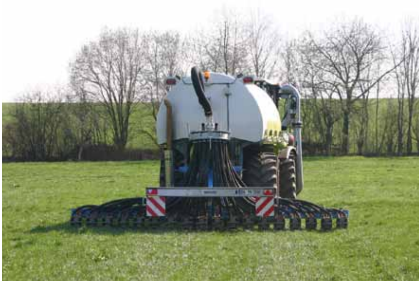
Das „All-Track“-Schlitzgerät des niederländischen Herstellers Duport kann mit Arbeitsbreiten von 4,4 bis 8 m an jede Fasstechnik angebaut werden, ob gezogen oder Selbstfahrer. Vorteile auf Grünland: Das Gras bleibt sauber und es werden keine Grasreste zusammengezogen, weil die Schleppschuhe die Form von Schlittschuhen haben.
