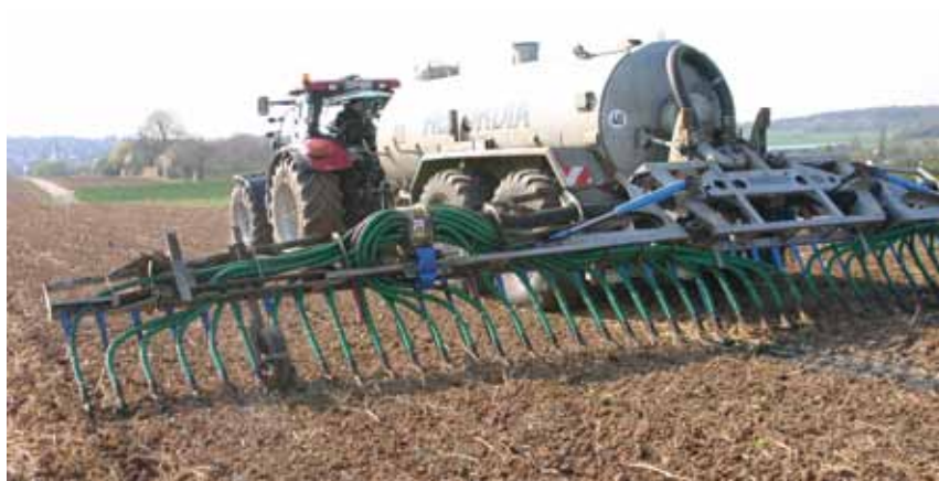
Der Schleppschuhverteiler Multi von Bomech für Grünland, Getreide und Ackerland. Die Kombination aus integriertem Hangaussgleichssystem und einzeln gefederten Schleppschuhen ermöglicht eine optimale Anpassung an schwierigste Geländebedingungen.
