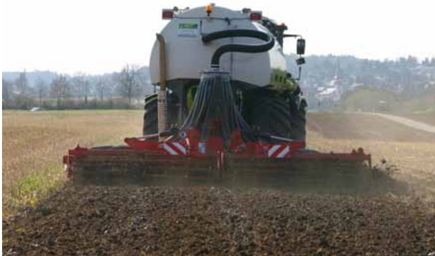
SGT-Aufbau für einen Claas Xerion VC (SGT=Silage- und Gülletechnik Schönebeck). Die Abbaupzeit beträgt etwa 45 Minuten und ist aufgeteilt in 2400 l und 12 500 l. Die Einarbeitung übernimmt eine Gülle-Kurzscheibenegge von Maschio.
