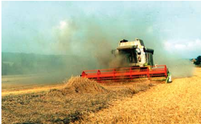
Lagergetreide führt zur deutlichen Leistungsminderungen, die je nach Schwere bei bis zu 80 Prozent liegen können. Fotos: Feiffer
