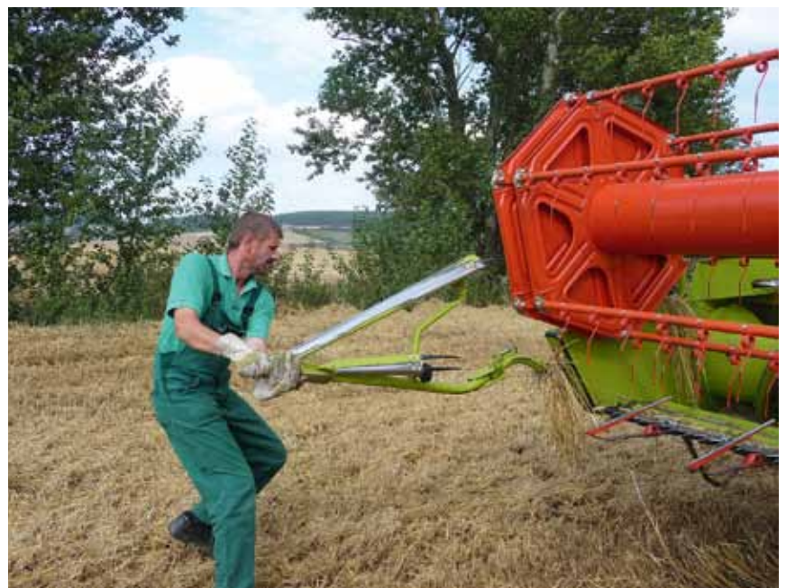
Halmteiler müssen in Flucht laufen, sonst schneidet man Kämme.
