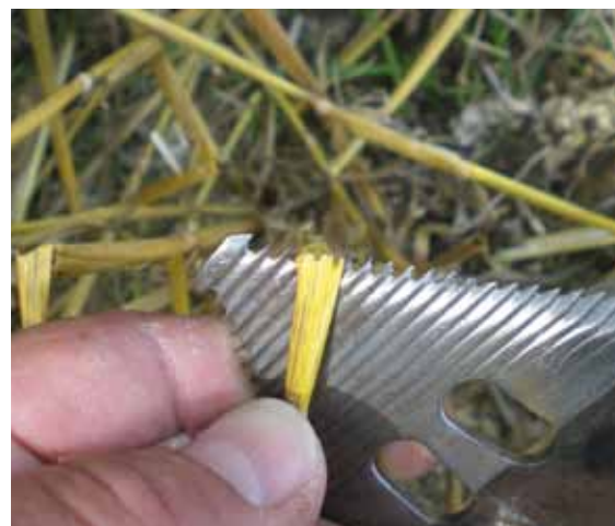
Bei verschlissenen Klingen werden aufgespießte Halme in die Mähfinger gezogen. Vibrationen und erhöhter Kraftaufwand sind die Folge.
