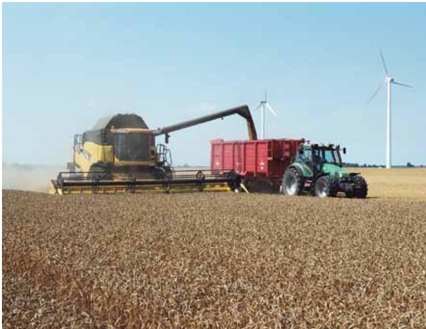
Hochleistungsmähdrescher ernten in jeder Minute eine Tonne Korn. Dabei wird die Abfuhr schnell zum Nadelöhr.
