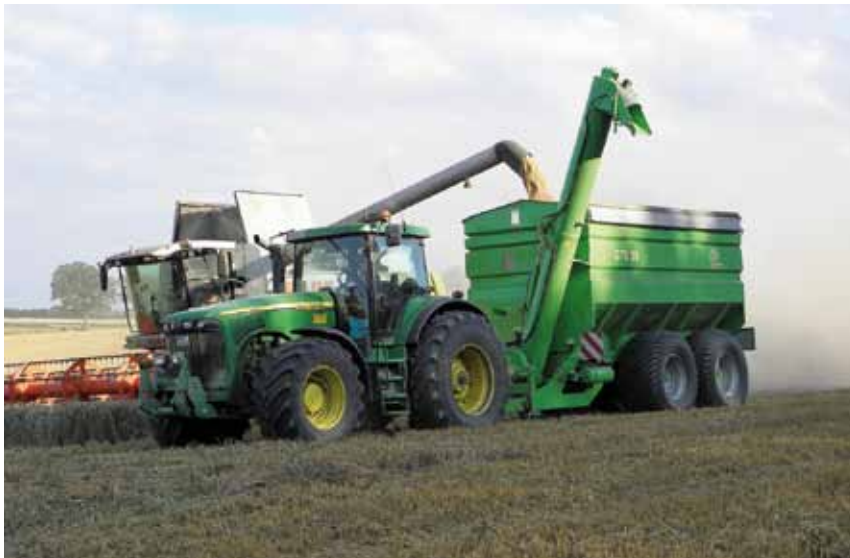
Durch den Umladewagen werden im Gut Derenburg etwa 17 ha an einem 10-Stundentag mehr abgeerntet.
