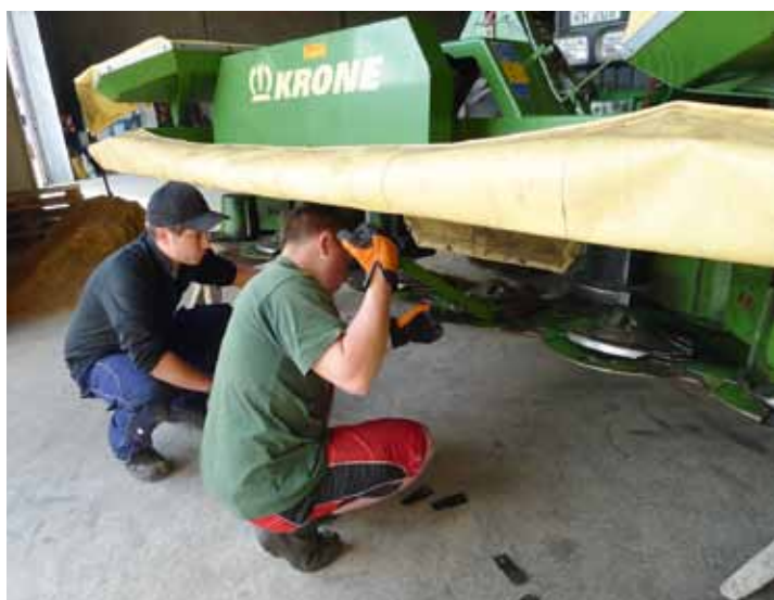
Nach den schriftlichen Prüfungen stellten sich die 20 Fachschüler den Prüfungskommissionen, um ihr Können bei der Anleitung von Auszubildenden unter Beweis zu stellen. So zeigt das Bild links, wie der Messerwechsel am Mähwerk erfolgt sowie das rechte Bild die Einstellung am Ladewagen.
