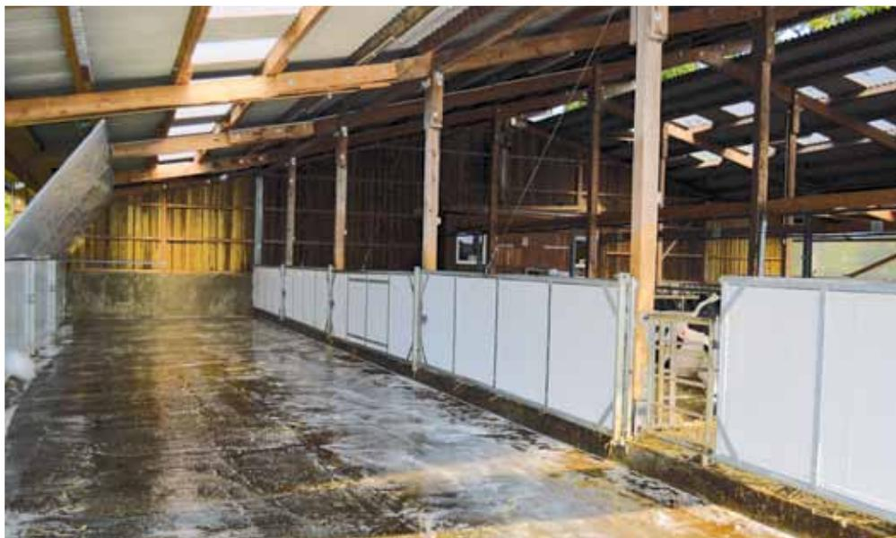
*Im Holsteiner Kälberstall besteht aufgrund der durch eine Aufkantung getrennten zwei Entmistungsachsen pro Stallseite die Möglichkeit, nach dem Entmisten den Gang zu waschen und zu desinfizieren. Die Kälber bleiben während dieser Zeit in der anderen Buchtenhälfte.*
