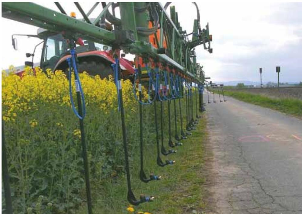
*In Hessen wurden Feldversuche durchgeführt, um die Eignung von tiefergelegten Düsen, sogenannten Droplegdüsen, zur Bekämpfung von Rapskrebs und Blütenschädlingen im Raps zu überprüfen.*
