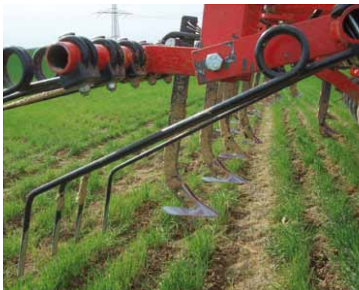
Der Einböck Row Guard mit automatischer Kameralenkung; hier im Einkorn auf dem Betrieb Hecker, Eppingen, mit 16 cm breiten Gänsefußscharen und 30 cm Reihenweite. Fotos: Böcker
