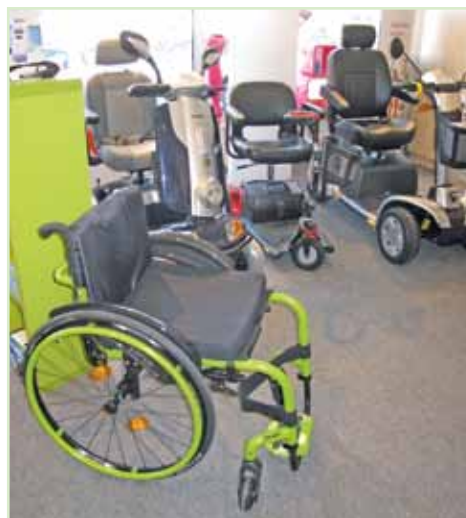
Rollstühle werden in drei Kategorien unterteilt: Neben den üblichen Leichtgewichtrollstühlen (auch Schieberollstuhl genannt) gibt es Pflegerrollstühle, wie sie die medrob-Mitarbeiterin im linken Bild zeigt. Sie sind wie Sessel. Der Pflegebedürftige kann darin bis in die Liegeposition gebracht werden. Aktivrollstühle (rechtes Bild, vorne) sind leicht, wendig und werden selbst bedient. Im Bildhintergrund sieht man Elektromobile.
