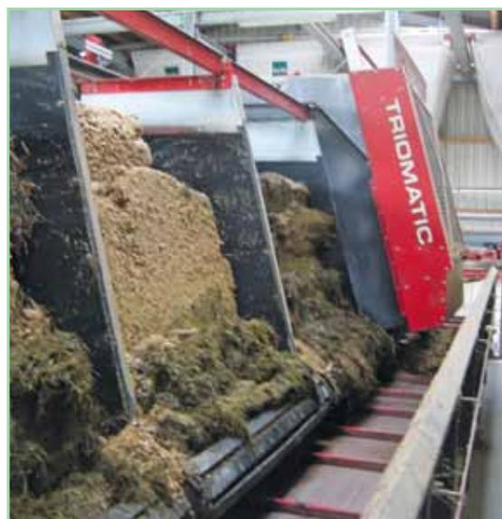
*Wichtig ist die exakte Zudosierung der einzelnen Futterkomponenten. Mit einer Schneidvorrichtung mit Doppelmesser (im Bild Hersteller Trioliet) ist dies gut möglich.*
