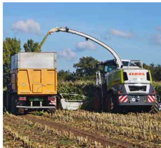
Shredlage-Mais beruht auf einem neuartigen Verfahren. Der Mais wird mit einem besonderen Cracker im Feldhäcksler bearbeitet. Fotos: Pries
