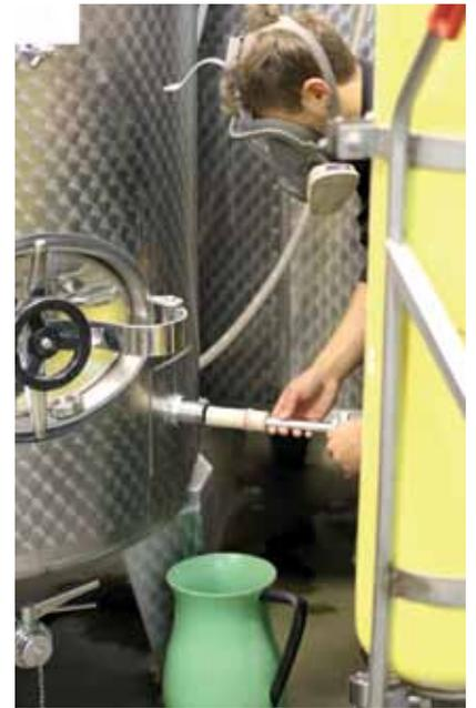
Das Gefahrenpotenzial der unter Druck stehenden Schwefeldioxid-Flaschen ist hoch. Der Umgang mit Ammoniumbisulfit und Kaliumhydrogensulfit ist sehr viel sicherer. Foto: Schandelmaier
