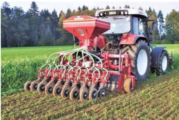
Auch der Geohobel, eine Maschine für minimale Bodenbearbeitung, mit der man auch säen kann, wird zu sehen sein. Foto: Rath Maschinen
