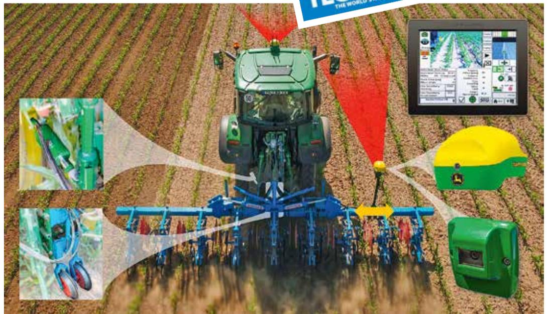
Die traktor-integrierte, aktive Anbaugerätelenkung für Reihenhacken „AutoTrac Implement Guidance“ ermöglicht die präzise Führung von Hackwerkzeugen zwischen Pflanzenreihen ohne den üblichen Verschieberahmen.
