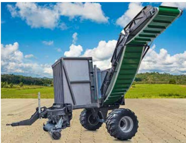
Der Fliegl Büffel ist ein Rotor-Lade-System mit Zwischenbunker.
