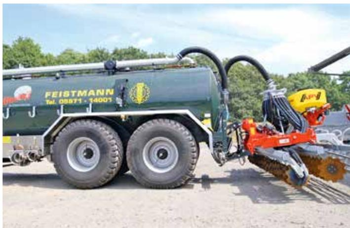
*Der LevelTuner von Wienhoff passt bei mehrachsigen Güllefässern in Abhängigkeit von der in der Deichselfederung gemessenen Stützlast den Luftdruck in den Federbälgen der vorderen Achse automatisch an. So wird eine ausreichende Stützlast sichergestellt und die Fahrsicherheit auf der Straße erhöht.*
