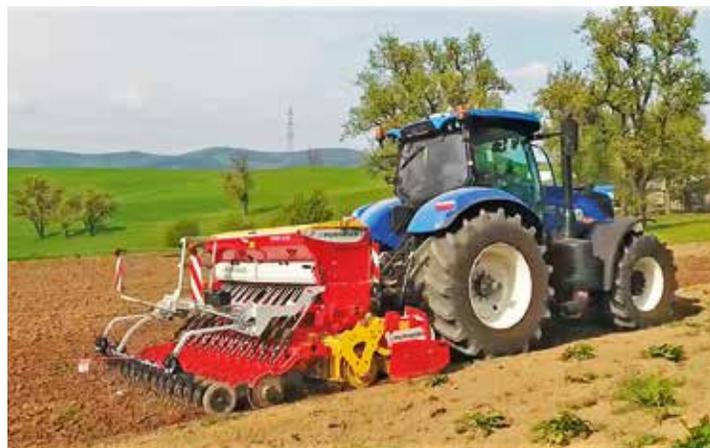
Bei der von Pöttinger angemeldeten Technik wird mit Kameras die Oberflächenrauigkeit hinter der Kreiselegge festgestellt und anschließend von der Rechereinheit an die Implement-ECU übergeben. Um die gewünschte Oberflächenstruktur zu erzielen, regelt das Gerät automatisch die Geschwindigkeit des Traktors und die Zapfwelldrehzahl der Kreiselegge.
