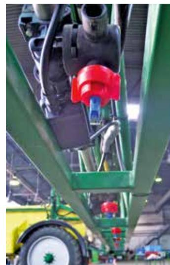
*Das Lechler ESV (Elektrisches-Schließ-Ventil) bildet eine Einheit aus Ventil, Verkabelung und Stecker für eine einfache und verwechslungsfreie Montage auf Einzel- oder Mehrfachdüsenträgern.*
