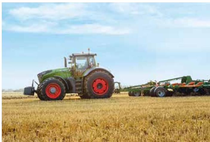
*Mit dem Fendt VarioPull kann erstmalig die Position des Anhängepunktes von Geräten auch während der Arbeit horizontal um bis zu 80 cm hin zur Hinterachse frei eingestellt werden.*
