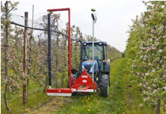
Das Darwin SmaArt Kamerasystem ersetzt die subjektive Einschätzung der Blühstärke mit dem Auge durch eine objektive Erfassung per Kamera. Die Daten werden in Echtzeit an den Bord-Rechner weitergeleitet und die optimale Spindeldrehzahl zur Ausdünnung eingestellt. **Werkfotos**
