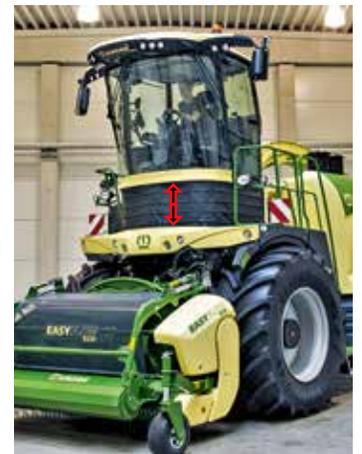
*Bei der Krone LiftCab wird die Ka-bine auf Knopfdruck um 70 cm an-gehoben; so hat der Fahrer einen guten Überblick über den Bestand.*
