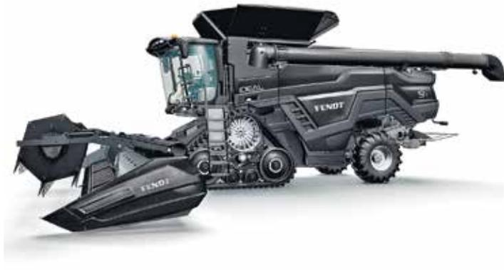
Der neu entwickelte Mähdrescher IDEAL von AGCO ist der einzige Oberklasse-Mähdrescher, der bei Nutzung bodenschonender Fahrwerkstechnik die Transportbreite von 3,3 Metern nicht überschreitet. Werkfotos
