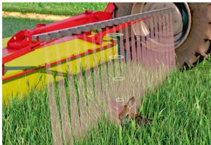
*Mit dem am Mähwerk installierten Sensorbalken Sensosafe können ver-steckte Wildtiere über Infrarotsensoren mit integrierter LED-Beleuchtung während des Mähens erkannt und somit vor dem Mähod bewahrt werden.*
