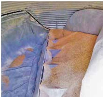
*Das Flexwave Grain Silo Unloading System besteht aus zwei Luftkissen, die zum Restentleeren des Silos aufgeblasen werden.*
