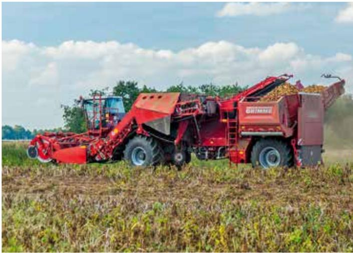
*Grimme hat beim Kartoffelroder Ventor 4150 erstmals das knollenscho-nende und leistungsstarke Schrägelevator-Erd- und -krauttrennsystem in eine vierreihige, selbstfahrende Kartoffelerntemaschine unter Einhaltung einer Transportbreite von 3,5 m integriert.* **Werkfotos**
