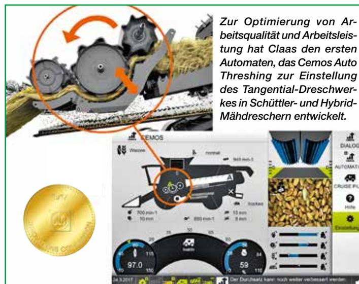
Zur Optimierung von Arbeitsqualität und Arbeitsleistung hat Claas den ersten Automaten, das Cemos Auto Threshing zur Einstellung des Tangential-Dreschwerkes in Schüttler- und Hybrid-Mähdreschern entwickelt.
