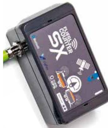
Der COUNTER SX nutzt die Funktechnologie Sigfox, 3D-Sensoren und GPS. Über Sigfox besteht eine günstige Internetverbindung und eine mobilfunkunabhängige Kommunikation zwischen Maschine und Betrieb.
