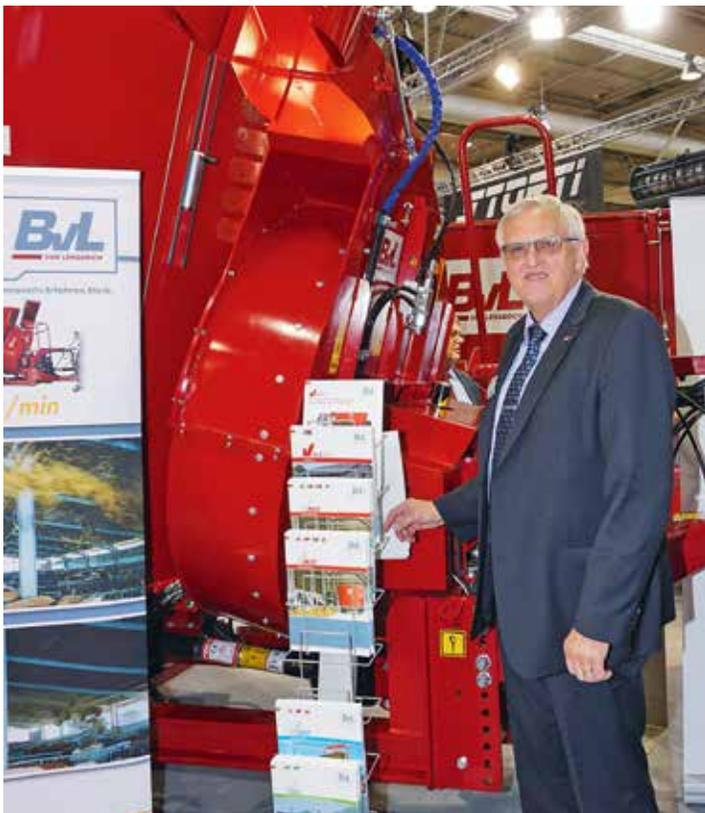
*Ein Strohgebläse, das an der Front oder am Heck eines Futtermischwagens angebracht werden kann, stellte für die Firma Bernard van Lengerich (BvL) Hans-Wolfgang Kurzenknebe von der gleichnamigen Werkvertretung vor. Das Strohgebläse kann das Stroh bis zu 20 Meter weit in den Stall werfen. So kann bequem vom Futtertisch aus eingestreut werden.*
