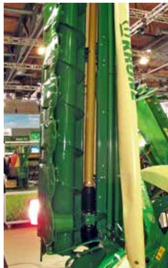
Beim neuen EasyCut B 950 Collect von Krone transportieren Querförderschnecken das Erntegut zur Mitte.
