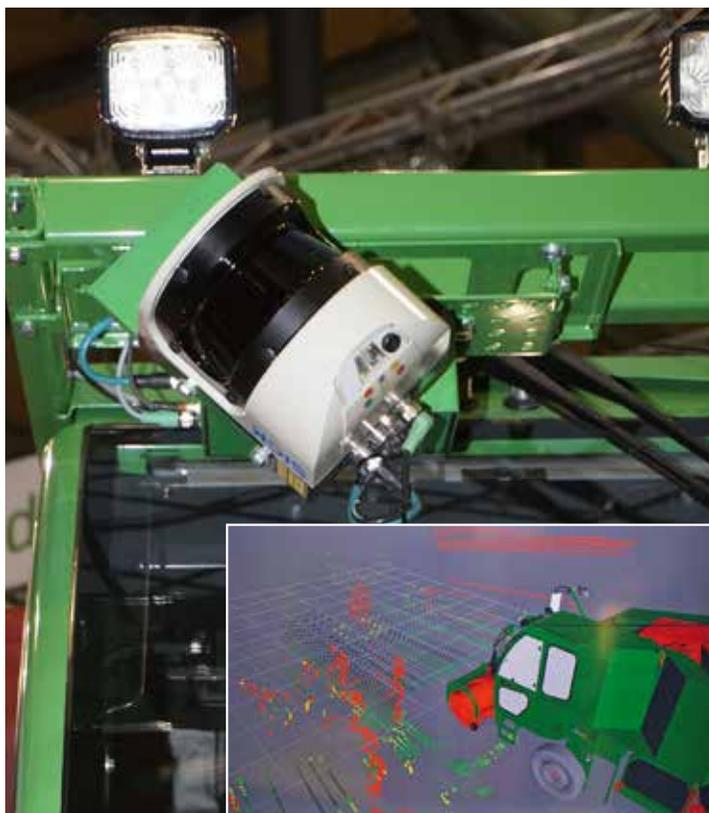
Die Firma Strautmann wird 2019 ein Head-on-System auf den Markt bringen, das einen Selbstfahrer autonom fahren lässt. Dazu werden dem Selbstfahrer Sensoren aufgesetzt (siehe großes Bild), die ein Live-Bild von der Umgebung erstellen (kleines Bild) und so Gefahren und Hindernisse erkennen und darauf reagieren kann.
