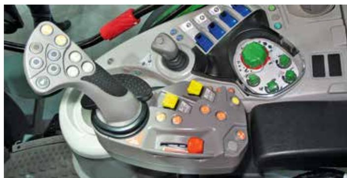
Die neu entwickelte rechte Konsole in den stufenlos-schaltbaren Deutz-Traktoren der 6-er Baureihe.
