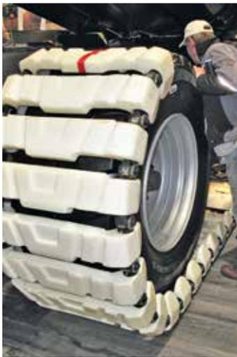
Die Felastec-Raupenbänder können über die Räder von Doppelachsigen Anhängern montiert werden.
