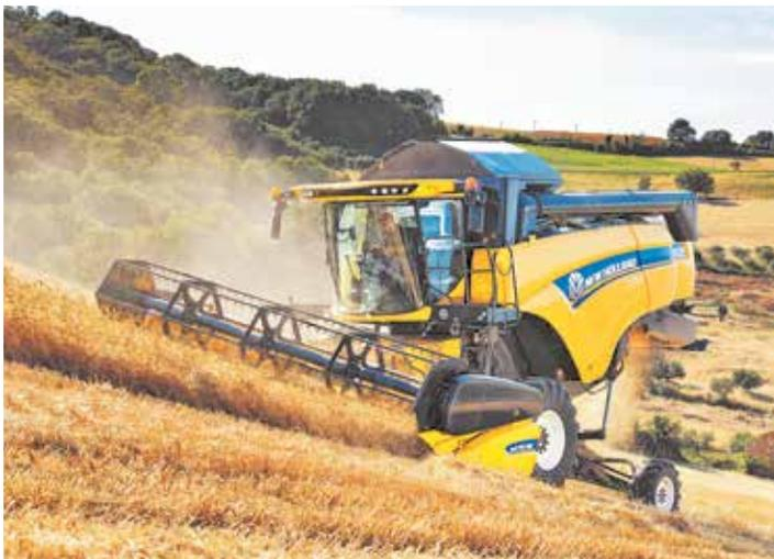
*Die neue Mähdrescher-Serie CX5/CX6 mit fünf oder sechs Schüttlern kommt auch in hängigem Gelände zurecht. Mit dem patentierten Smart Sieve-System von New Holland lässt sich die Bewegung des Siebs an Hangneigung und Korngröße anpassen.* *Werkbild*
