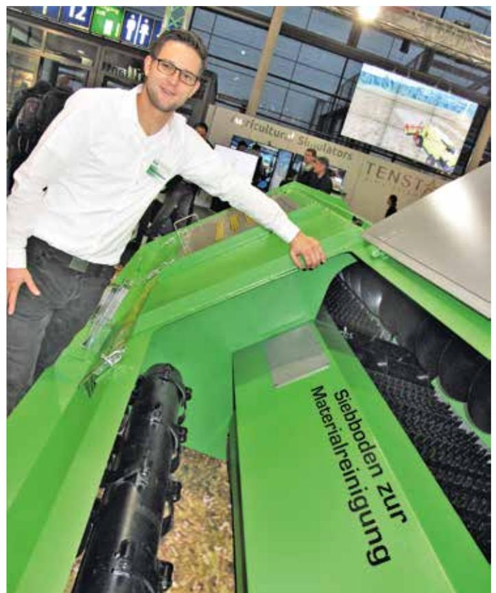
Marvin Gentsch erläutert das Prinzip des „Strohmax 5000“, einem Mais-häckser-Vorsatz, der die Stoppeln zerschlägt und gleichzeitig in die Maschine befördert.
