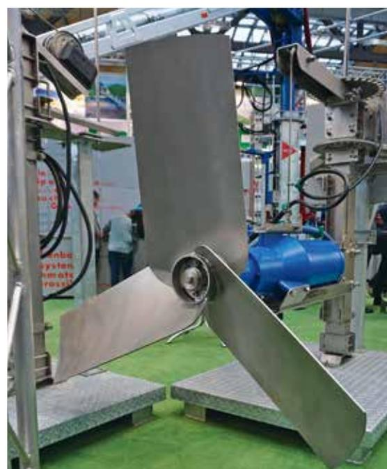
*Die Siliermitteldosierung Siljet (linkes Bild) für den Reck Jumbo II Grassilageverteiler benötigt keinen zusätzlichen Antrieb und ist von der Fahrerkabine aus steuerbar. Reck stellte ebenfalls das Rührwerk Orka Ex vor, das speziell für den Einsatz in Biogasanlagen konzipiert wurde. Der Tauchmörtormixer zeichnet sich nach Angaben von Reck durch ein langsames, gleichmäßiges Rühren aus.*
