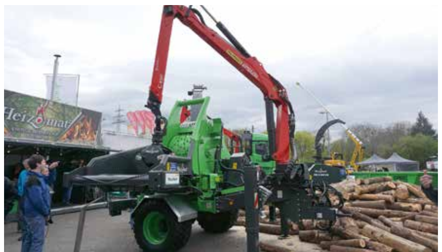
Effektiv Hackschnitzel zu produzieren, geht mit dem HM 8-500 K nun noch besser. Die knapp 10 t wiegende Hackeinheit mit Kran ermöglicht mehr Flexibilität. Fotos: zep
