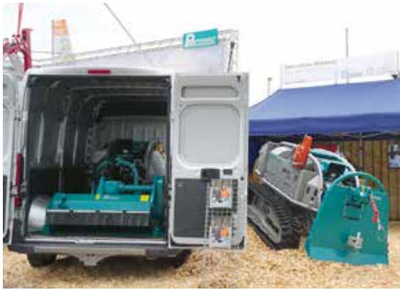
Der Moritz Fr 50 von der Firma Pfanzelt ermöglicht nicht nur das Rücken, sondern ganz neue Arbeitsweisen: Handlich, von höchster Arbeitssicherheit und mobil sind damit Kommunen, Forst- und Spezialbetriebe. Der Moritz Fr 50 passt sogar in einen Kleintransporter.
