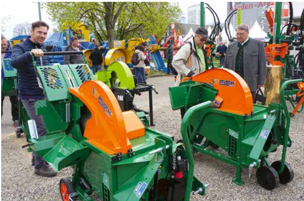
Die zwei Modelle: Rechts die Wippkreissäge von Posch ohne Sicherheitsgriff, links mit Sicherheitsgriff und Schutzklappe und somit gemäß der neuen Anforderungen der Berufsgenossenschaft.
