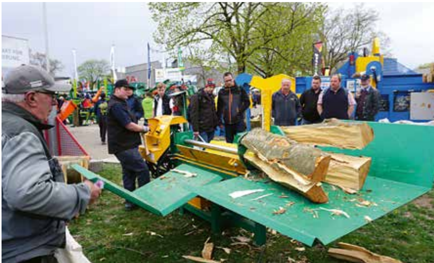
Der Kretzer SK 1200/30, ein Liegendspalter mit hydraulischen Seitenwangen kann auch kleinere Durchmesser mittig halten für eine optimale Ausbeute.
