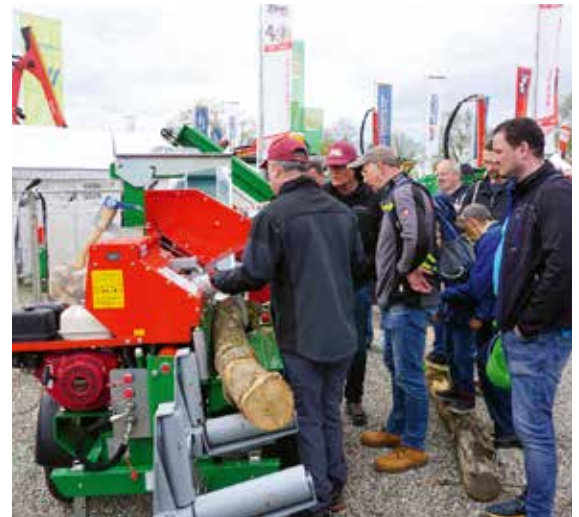
Der Thor Säge-spaltautomat Magika Universal ist auf ein Fahrwerk platziert und kann so mit Benzin betrieben überall eingesetzt werden.
