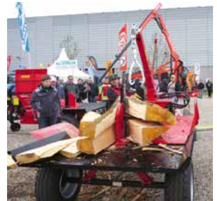
Bei Growi wurde der stationäre Standardspalter auf ein Fahrwerk gehoben.
