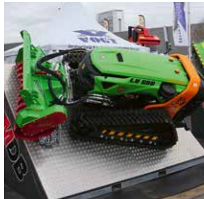
MDB Mulchraupen der Firma Vogt können Hangneigungen bis 70 Grad bearbeiten.
