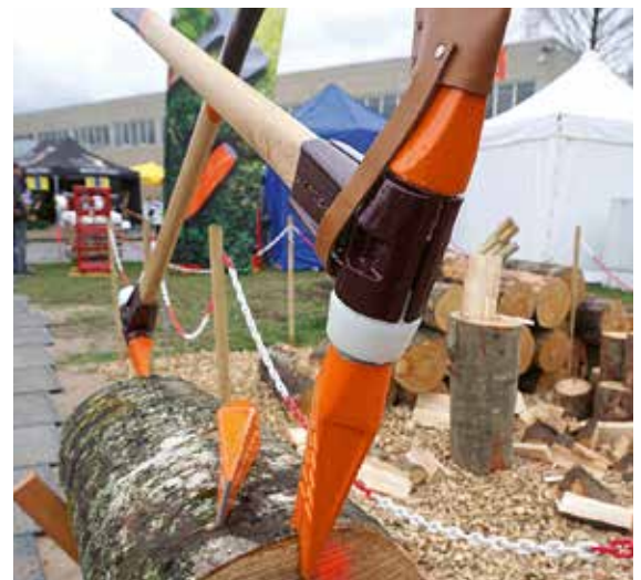
Die Firma Halder Forstwerkzeuge bot Simplex-Hämmer für den Einsatz auf Stahlkeile an. Mit diesen werde die kinetische Energie ohne Verluste übertragen.
