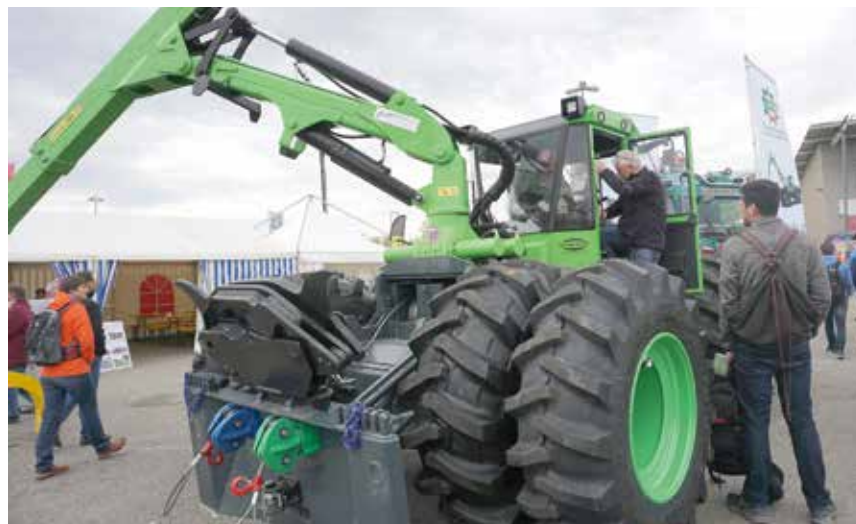
Die Firma Christoph Heinemann Forst- und Landtechnik aus Meschede zeigte den Forstspeziialschlepper Equus 175 N mit Doppelbereifung für besonders bodenschonendes Arbeiten in feuchten Beständen, die es diesen Winter vielerorts gab.
