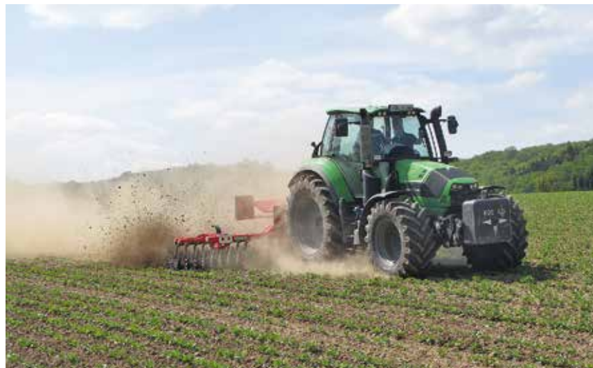
Trotz viel Bodenbewegung konnte das Arbeitsbild der Rotorhacke Rotarystar (Einböck) am Standort in Zierenberg nicht überzeugen. Die nur etwas tieferliegende Fahrspur wurde nicht erfasst (unten). Hier zeigte sich, dass dieses Gerät vor allem dazu konstruiert wurde, oberflächliche Verkrustungen aufzubrechen. Fotos: Becker
