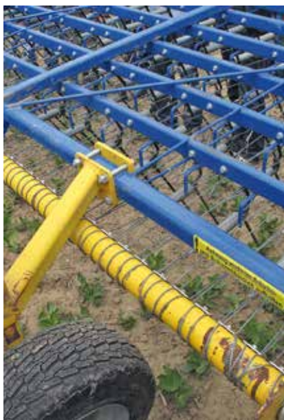
Der Treffler-Präzisionsstriegel kann durch die patentierte Zinkenaufhängung Bodenunebenheiten ausgleichen und in hohen und niedrigen Kulturen eingesetzt werden.
