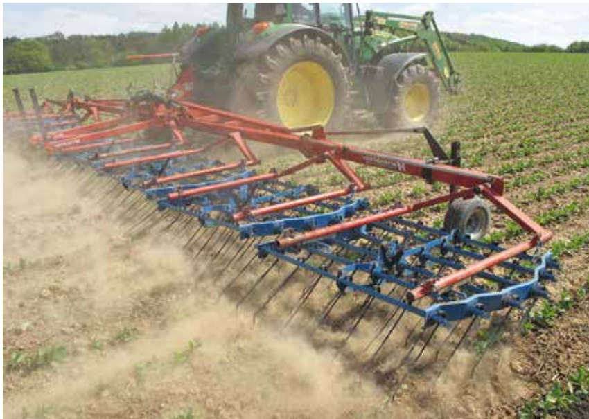
Der 12-m-Hackstriegel von Hatzenbichler ist laut Ralf Bernd vom örtlichen Maschinenring ideal zum Blindstriegeln. Das einfache, schon ältere Gerät leistete gute Arbeit und hätte genauso gut quer zu den Reihen fahren können, so Bernd. „Die verschütteten Bohnen stehen wieder auf. Wichtig sind hierbei breite Reifen mit wenig Druck.“
