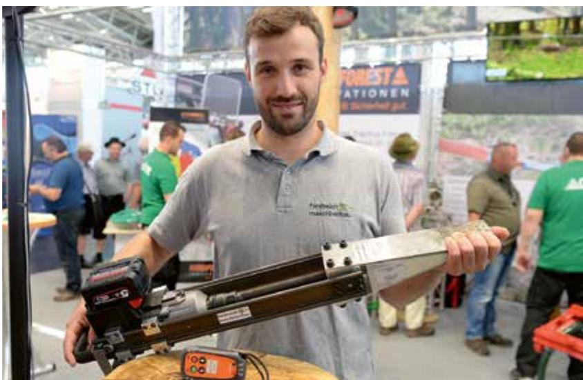
Inzwischen können Fällheber auch per Funk aus sicherer Entfernung betätigt werden, ein weiteres Plus für die Sicherheit der Waldarbeit. Fotos: landpixel
