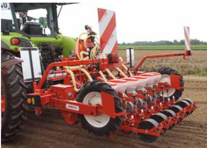
Die Agravis Technik Hessen-Pfalz stellte die hydraulische Einzelkornsämaschine Orietta von Gaspardo vor. Sie ist vielseitig für verschiedene Gemüsearten einsetzbar und für die genaue Ablage des Saatkorns in Einzelreihe, Doppelreihe, Dreifachreihe oder auch Bandsaat geeignet.
