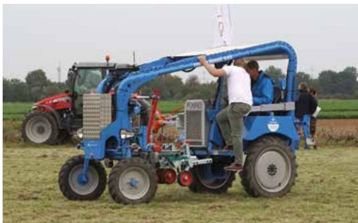
Das Schweizer Unternehmen Baertschi hatte seinen bereits bewährten Geräteträger Fobro-Mobil dabei, der viele Anbauvarianten zulässt und eine gute Sicht auf die Arbeitsgeräte garantiert. Neu ist die Nachrüstungs-option mit einem RTK-Lenksystem von Topcon und einem Seitenwechselrahmen mit Ultraschallsonden PSR SONIC von Reichard.
