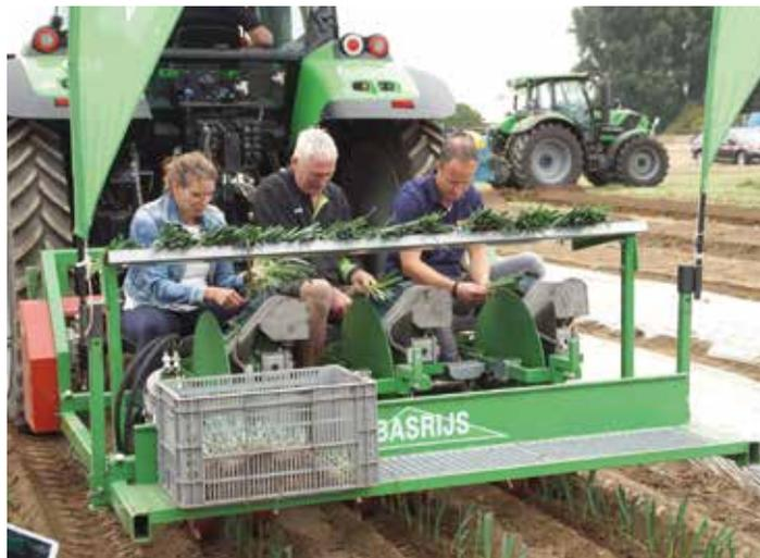
Von der niederländischen Firma Basrijs wird diese Scheibenpflanzmaschine für Porree hergestellt. Fotos: Brammert-Schröder
