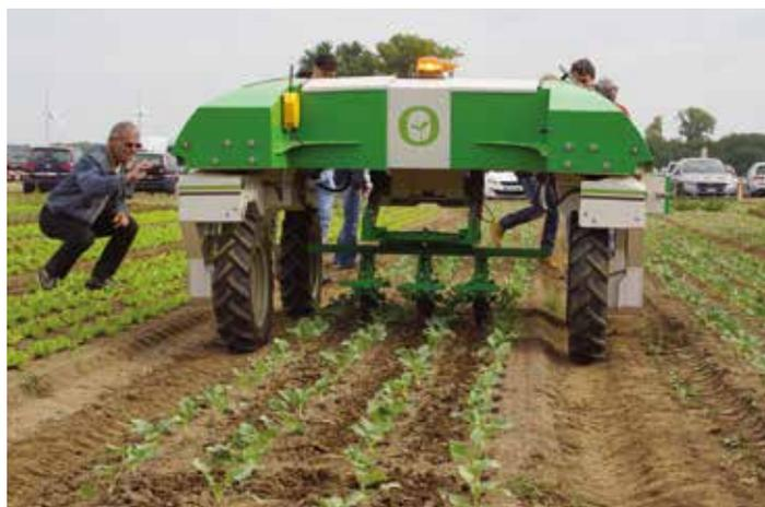
Der selbstfahrende Roboter der Firma Naio kann mit vielerlei Werkzeug ausgerüstet werden. Die Akkuleistung reicht bis zu acht Stunden.
