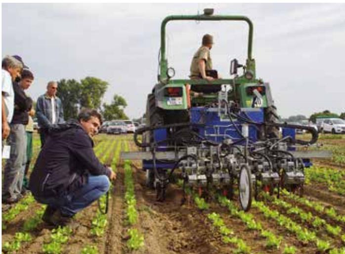
Der kameragesteuerte Robovator von der Firma Kult ermöglicht das Arbeiten zwischen und innerhalb der Reihen.
