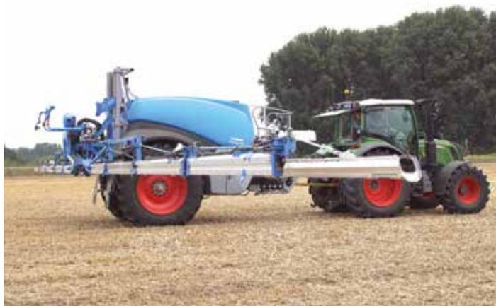
Die neue Lemken-Anhängerspritze gibt es bis 30 m Arbeitsbreite. Jede Düse kann einzeln ein- oder ausgeschaltet werden.
