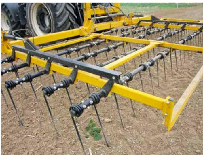
Strohstriegel von Claydon – 7,5 Meter.
