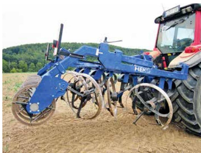
*Heko-Ringschneider, 3 m, selbstschärfende Schneide als Zusatz mit Heko-Schneidmesserwalze*
