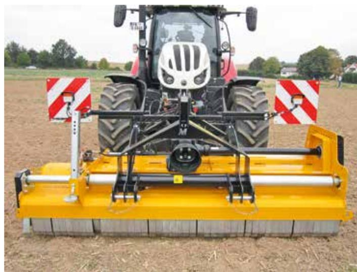
*Müthing-Vario-Pro 280, mit Seitenverschiebung und hydraulisch verstellbarer Schneidschiene.*
