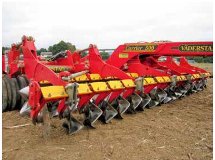
**Väderstad: Carrier CrossCutter Disc, 5 m, ultraflache Bodenbearbeitung.**
