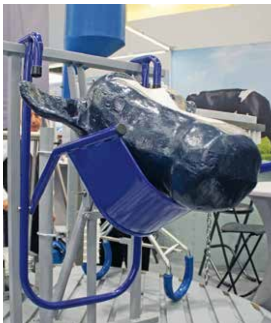
Die Kopfstütze von Vink (linkes Bild) erleichtert die Behandlung von Kühen. Damit kann der Kopf sicher fixiert werden. Mit Moomall Heat ist eine Brunstüberwachung auch auf der Weide möglich. Das Halsband, das der Bulle trägt (mittleres Bild), korrespondiert mit den RFID-Ohrmarken der Kühe. Sensoren in Bolusform (rechtes Bild), die im Pansen der Kuh Temperatur und Bewegungsaktivität messen und in einer App auf dem Smartphone Maßnahmen und Gesundheitsstatus aufzeigen, stellte die Firma Dropnostix vor. Fotos: Brammert-Schröder/Krämer
