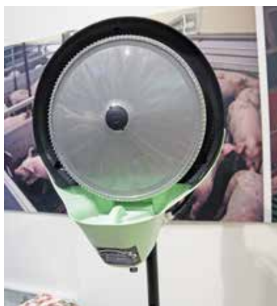
Die Firma Schulze Bremer stellte einen Wasserkühler für Schweineställe vor (linkes Bild), der Wasser zu feinem Nebel zerstäubt und etwa 35 Meter weit verteilt. Dazu dreht ein Motor die Scheibe sehr schnell und vernebelt so etwa 80 Liter Wasser in der Stunde. Ein Bügel in einer Saugferkeltränke sorgt dafür, sodass die Ferkel spielerisch ab dem ersten Lebenstag die Tränke benutzen (mittleres Bild). Mit einer einfachen Halterung für Seile können diese zentimeterweise in die Bucht gegeben werden und müssen nicht mehr festgeknotet werden (rechtes Bild).
