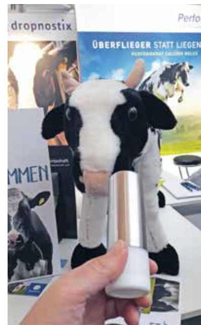
Die Kopfstütze von Vink (linkes Bild) erleichtert die Behandlung von Kühen. Damit kann der Kopf sicher fixiert werden. Mit Moomall Heat ist eine Brunstüberwachung auch auf der Weide möglich. Das Halsband, das der Bulle trägt (mittleres Bild), korrespondiert mit den RFID-Ohrmarken der Kühe. Sensoren in Bolusform (rechtes Bild), die im Pansen der Kuh Temperatur und Bewegungsaktivität messen und in einer App auf dem Smartphone Maßnahmen und Gesundheitsstatus aufzeigen, stellte die Firma Dropnostix vor. Fotos: Brammert-Schröder/Krämer
