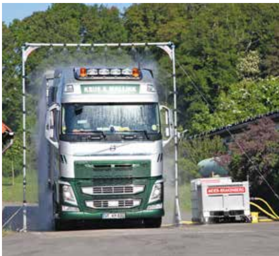
Das stationäre Desinfektionstor von Meier-Brakenberg kann an Hofein- und -ausfahrten angebracht werden, um den eigenen Betrieb zu schützen. Die Desinfektion wird automatisch durchgeführt. Werkfoto
