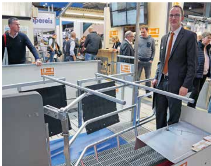
Systeme zur Raufuttergabe stellte die Firma Ibo-Stalltechnik vor (linkes Bild). Mit dem neu entwickelten Strohdosierer für das 60er HS-Futtertransportsystem kann Raufutter bis 8 cm Halmlänge zu den speziellen Automaten gefördert werden. Eine Verbesserung in der Sow-Take-Away-Abferkelbucht zeigte Christoph Luttermann von Hölcher und Leuschner. Durch geschwungene Matten, die an einer Seite des Ferkelkorbes angebracht werden, soll sich die Sau mit dem Gesäuge Richtung Ferkelnest legen, da die Tiere sich lieber an geschlossene Seiten legen, wie Luttermann sagte.
