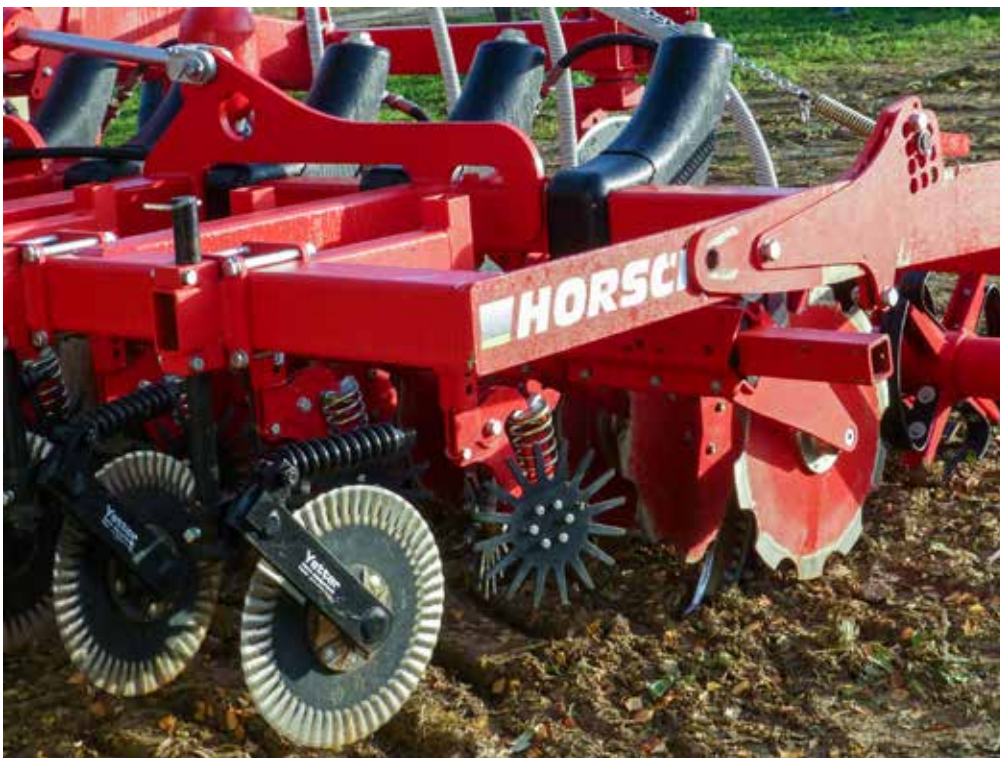
Durch das Strip-Till-Verfahren lässt sich eine Bodenlockerung sowie tiefere Einbringung von Dünger kombinieren. Fotos: Dr. Brust
