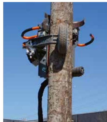
Der Patas von der Firma advaligno wird die Entastung revolutionieren und mehr Wertholz ermöglichen. Fotos: Setzpfand
