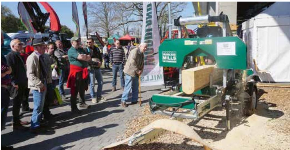
Das mobile Sägewerk der Firma Woodland Mills aus Kanada wird von Paintinger Forst- und Kommunaltechnik vertrieben. So kann das eigene Stammholz direkt in Bauholz umgewandelt werden.
