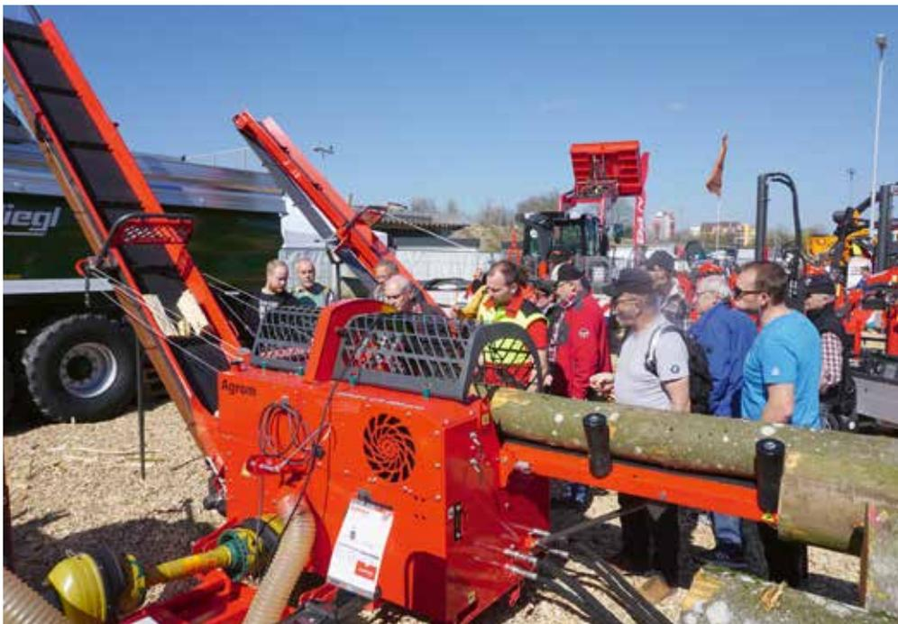
In Aktion konnte der Sägespalter der Firma Krpan auf dem Stand der Agrom Agrartechnik GmbH gesehen werden. Stämme von 10 bis 42 cm Durchmesser werden mit 16 t Spaltkraft geteilt und mit einem Husqvarna-Schwert gekürzt.
