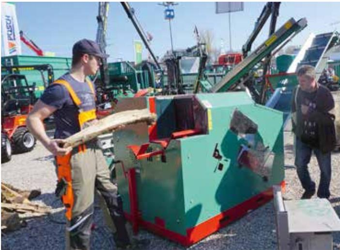
Dieser Prototyp einer vollautomatischen Wippsäge in Schräglage wurde von der Firma Oehler aus Offenburg vorgestellt. Die Industriebauweise ermöglicht hohe Sicherheit.
