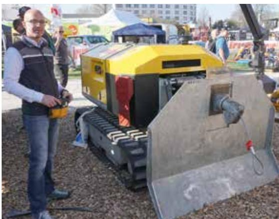
Rainer Bucher stellte am Stand der Firma Welte den Prototyp der Forstraupe W 60 vor. Diese wiegt 2,7 t und garantiert auch bei Höchstbelastung der 6 t-Winde einen festen Stand. Die Kosten liegen bei rund 90 000 Euro.
