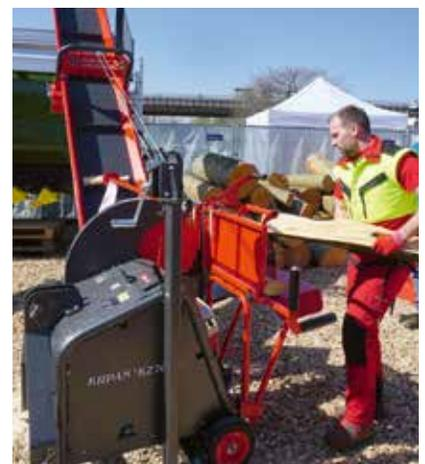
Die neue Kreissäge E 700 von Krpan kann Scheite bis 24 cm einkürzen. Motor und Antrieb sind aus Grauguss.
