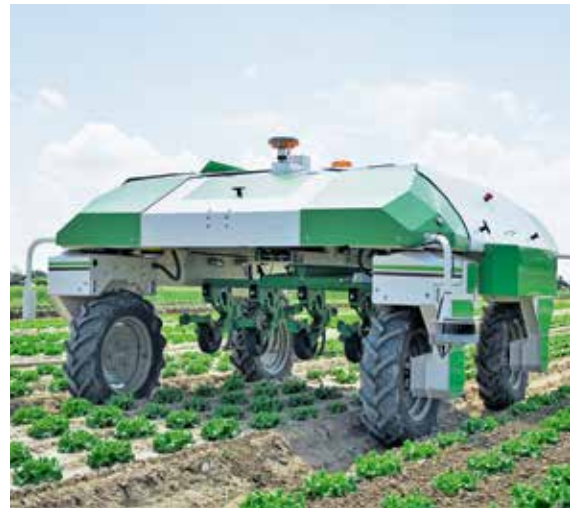
Der Großroboter Dino soll Unkräuter in großen Gemüsebeeten entfernen (s. Kasten). Foto: Naïo Technologies
