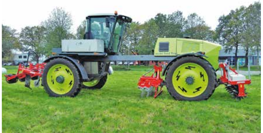
Der MultiToolTrac ist ein elektrisch angetriebener Traktor mit langem Radstand, drei Anbaupositionen (Front-, Zwischenachs- und Heckanbau) sowie einer Allradlenkung und Allradantrieb. Im Zwischenachs-Bereich hat der Fahrer einen sehr guten Blick auf seine Arbeit. Die Spurweitereinstellung erfolgt auf Knopfdruck und ermöglicht ein Beetenbausystem mit festen Fahrgassen. Foto: MultiToolTrac
