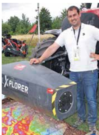
Philipp Härterich, CNHI: Der „SoilXplorer“ Bodensensor analysiert die Bodenstruktur in vier verschiedenen Horizonten.“
