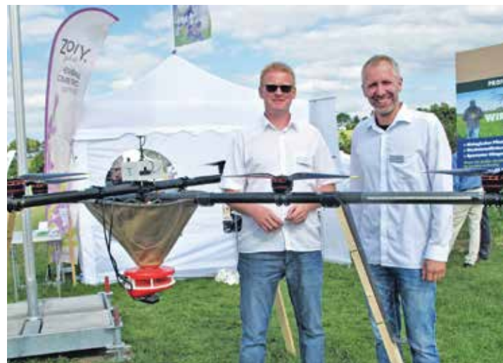
Die Agroflight GmbH, Borgentreich, bietet eine Drohne, die bis zu 20 kg Flüssigkeiten oder Feststoffe über dem Acker ausbringen kann. André Peine und Franz Leihkauf präsentierten die vielfältigen Möglichkeiten des Systems.
