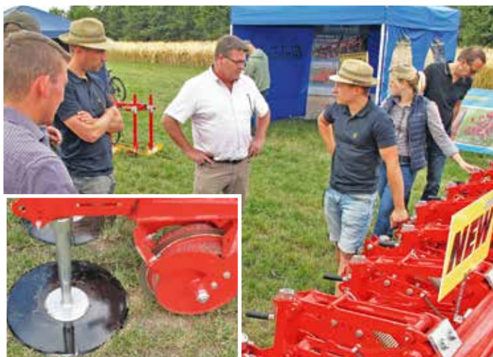
Landwirt Thomas Kunz informiert sich über den „Chopstar Hybrid“ von Einböck. Die flachen Scheiben (kleines Foto) sollen ein Verstopfungsfreies Hacken von Unkräutern in Mulchbeständen ermöglichen.
