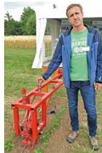
Dr. Jan Rücknagel mit dem von der Martin-Luther-Universität Halle-Wittenberg entwickelten Roll-Spurlockerer.
