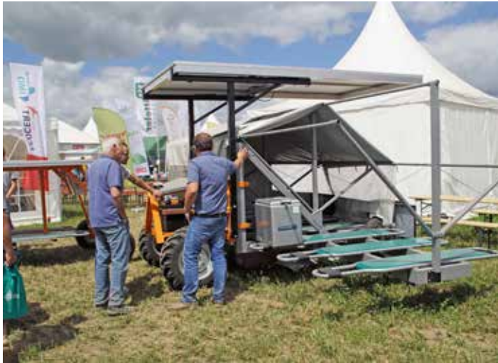
Je nach Größe der Maschine haben bis zu zwölf Personen auf dem Jäteflieger Platz, der aber auch für Erntearbeiten genutzt werden kann.
