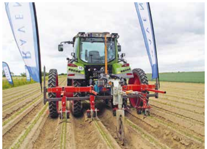
Das niederländische Unternehmen Raven demonstrierte in Frankenhausen, wie genau das voll skalierbare GPS-System RS1 arbeitet. Es integriert eine automatische Lenkung und eine sehr genaue GPS-gestützte Spurführung, sodass der Einsatz in Möhren möglich ist. Die Hackwerkzeuge arbeiten dicht an den jungen Pflanzen heran.
