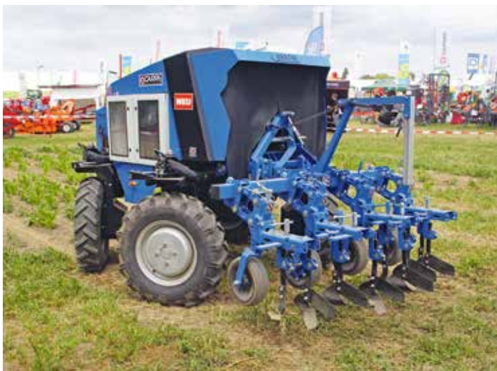
Der Unkrautroboter Anatis kann sowohl in Saatreihen mit Reihenabständen ab 20 cm als auch in Dammkulturen eingesetzt werden.
