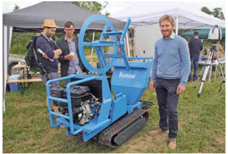
Viermann Sv-15M kann Unterflur-Bewässerungsschläuche bis 15 cm Tiefe verlegen.
