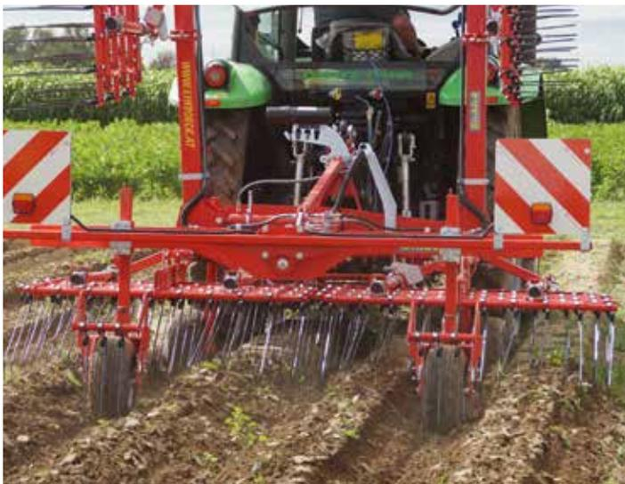
Der Exaktstriegel Aerostar Exact von Einböck eignet sich auch für Reihen- und Dammkulturen. Stützräder vorne und hinten ermöglichen eine präzise Tiefenführung.
