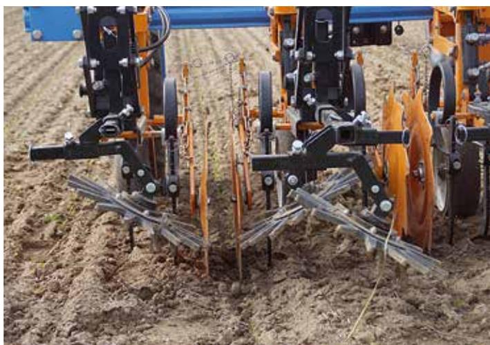
Die vorgestellte Hackmaschine von Schmotzer mit Schnellwechselfscharen war mit Hackschutzrollen ausgestattet, um die kleinen Pflanzen im Zweiblattstadium zu schützen. Eine Kombination mit einer Bandspritzeinrichtung ist möglich. Fotos: Brammert-Schröder
