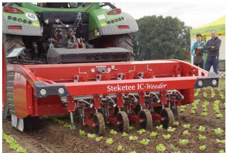
Auch mit der Hackmaschine IC-Weeder von Steketee lässt sich das Unkraut in der Reihe entfernen. Anhand von Kamerabildern werden sichelförmige Messer zwischen die Kulturpflanzen einer Reihe geführt.
