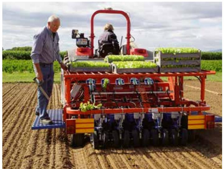
Mit der automatischen Pflanzmaschine Fast Block von Ferrari lassen sich Salat, Zwiebeln oder Möhren aus Presstöpfen mit einer Seitenlänge von 3,2 bis 5 cm pflanzen. Fotos: Brammert-Schröder
