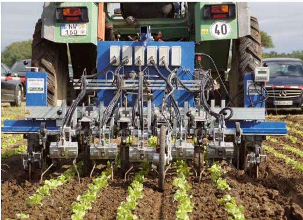
Mit dem Robovator lässt sich das Unkraut auch in der Reihe präzise entfernen. Eine Kamera über jeder Reihe unterscheidet zwischen Kulturpflanze und Unkraut, die Werkzeuge hacken den Bereich rund um die Kulturpflanze.
