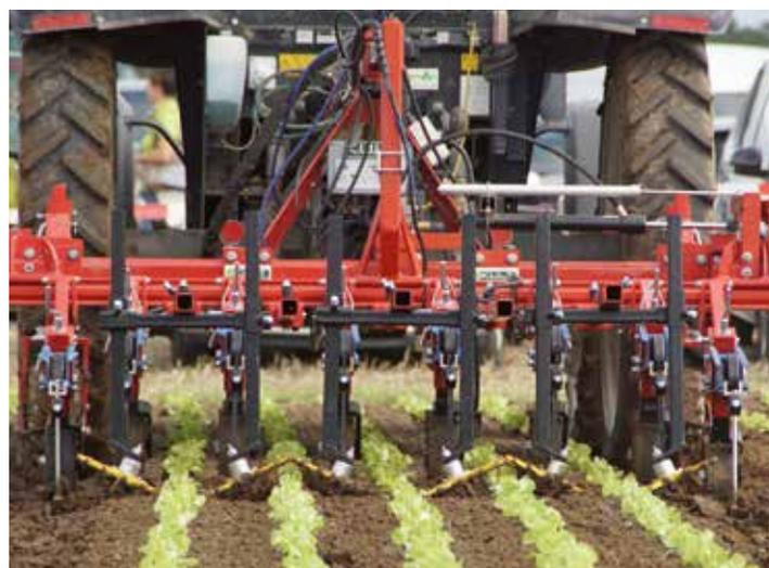
An der Hackmaschine von K.U.L.T. waren die Fingerhacken unterschiedlich eingestellt. Links arbeiten die Hackelemente flacher, rechts mit deutlich mehr Griff, so dass auch mehr Unkraut in der Reihe beseitigt wird.
