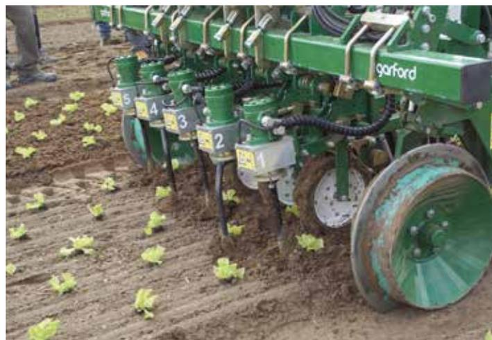
Die Hackmaschine Robocrop Inrow wird im Frontanbau gefahren. Rotierende sichelförmige Messer arbeiten um die Kulturpflanzen herum und beseitigen so das Unkraut in der Reihe. Sie werden von einem Kamerasystem gesteuert.
