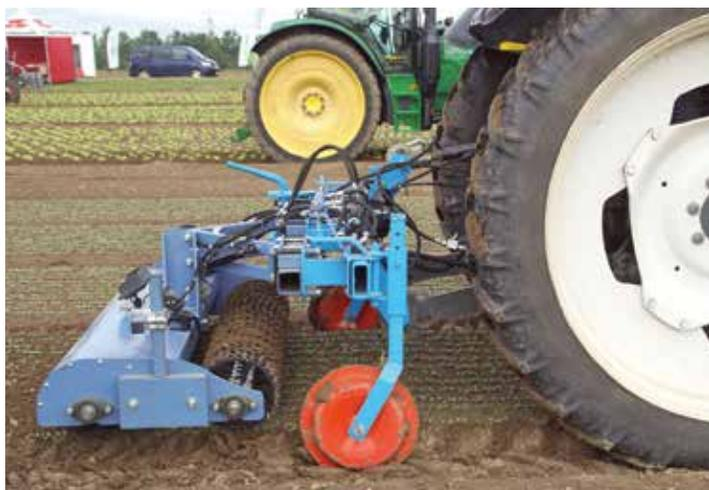
Mit der neu entwickelten Hackmaschine Dulks Abrah lassen sich Kulturen ab 5 cm Reihenabstand von Unkraut befreien. Krummzacken brechen den Boden, die dahinter laufenden Rotationsschare hebeln die Unkräuter aus dem Boden.
