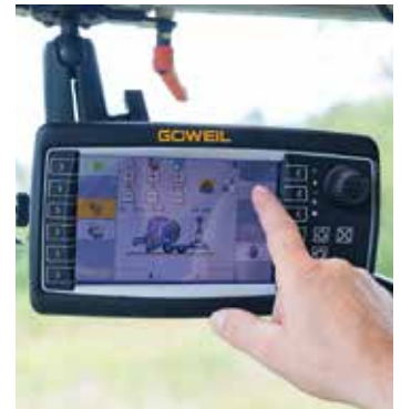
Die neue Isobus-Steuerung ist übersichtlich und einfach zu bedienen.
