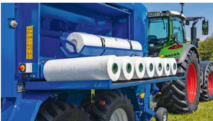
Im geschlossenen Folienmagazin können nun 14 Rollen Wickelfolie und 2 Rollen Mantelfolie verstaut werden.
