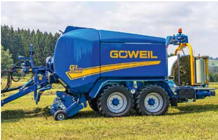
Die G-1 F125 Kombi von Göweil hat jetzt größer dimensionierte Reifen, wodurch die Bodenbelastung reduziert wird. Fotos: Werkfotos
