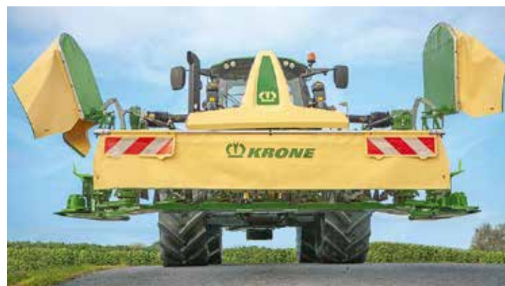
Das Krone-Scheibenmähdwerk EasyCut F 400 CV Fold mit Aufbereiter und einer Arbeitsbreite von 4,00 m bietet im Feldeinsatz alle Vorteile der größeren Arbeitsbreite. Für die Straßenfahrt werden die beiden äußeren Mäh-scheiben mittels eines klappbaren Mähholms nach hinten eingeschwenkt und bieten für den Straßentransport eine Breite von unter 3 m.
