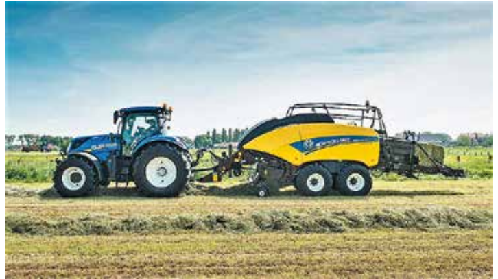
Das Baler-Control-System von CNH modifiziert die Abstimmung der Vorderachsfederung und erhöht die Steigung der Abregelkurve im Motorenkennfeld. Dadurch wird ein Aufschaukeln der Traktor-Geräte-Kombination vermieden.
