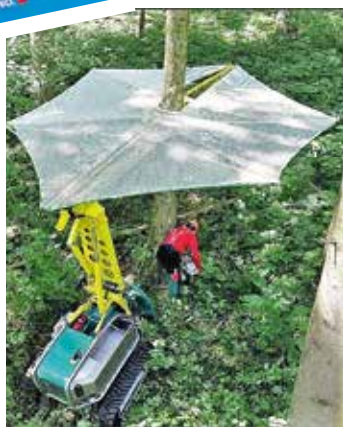
Der Personen-Schutzschirm von Pfanzelt ist an einer Forstraupe Moritz befestigt und wird vor dem Baum stehend hydraulisch ausgeklappt. Er schützt Arbeiter vor herabfallenden Ästen und Kronenteilen.
