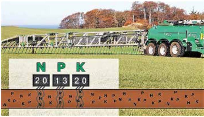
Samson bietet erstmals ein System zur Bestimmung von Stickstoff, Phosphor und Kali in Gülle an, das auf einem NMR-Sensor (Nuclear Magnetic Resonance, Kernspinresonanz) basiert.
