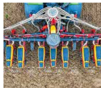
Das WideLining-System von Väderstad ermöglicht erstmals eine Fahrgassenschaltung ohne das Abschalten einzelner Saatreihen bei der Einzelkornsaat.
