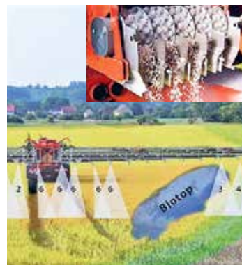
Das MultiRate-Dosiersystem für Pneumatikstreuer von Rauch regelt elektrisch die Dosierorgane jeder einzelnen Düngerauslassöffnung unabhängig voneinander stufenlos.
