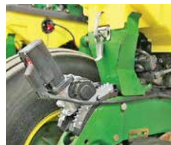
SmartDepth erlaubt die automatische und präzise Tiefensteuerung einer Einzelkornsämaschine je nach Bodeneigenschaften.
