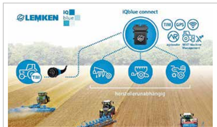
iQblue connect ist ein herstellerübergreifendes, nachrüstbares und portables Modul zur Automatisierung von Gerätefunktionen auf ISO-BUS-Basis. Werkfotos
