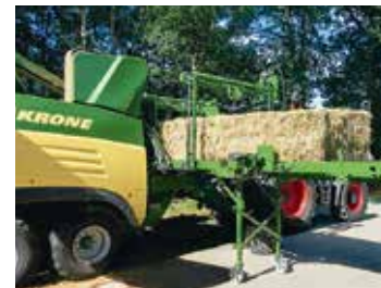
Mit der automatischen Garmentfernung werden beim stationären Einsatz der Pelletpresse Premos die Bänder aufgeschnitten, vom Ballen gezogen und sicher aufgewickelt.
