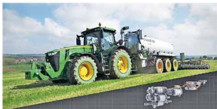
Das eAutoPower-Getriebe für die neuen 8R-Großtraktoren von John Deere stellt nun das erste elektrisch-mechanisch leistungsverzweigte Getriebe in der Landtechnik dar. Die dadurch mögliche Traktor-Geräte-Elektrifizierung wird an einer gemeinsam mit der Firma Joskin entwickelten Systemlösung für die Gülleausbringung demonstriert, bei welcher zwei Achsen eines Tridem-Güllefassens elektrisch angetrieben werden. Dafür verlieh die DLG-Neuheitenkommission die einzige Goldmedaille 2019.
