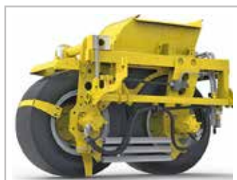
Bei der neuen Kartoffelquetsche von Ropa übernehmen zwei hydraulisch angetriebene, unterschiedlich schnell laufende Reifen das Zerquetschen der Knollen, um deren Auskeimen in der Folgekultur zu verhindern.
