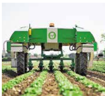
Der Roboter Dino ist das erste autonome Gerät zur mechanischen Unkrautbekämpfung in den Salatzeilen.
