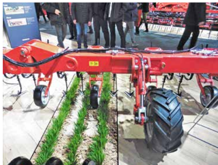
Dem Thema mechanische Schadpflanzenregulierung widmet sich Horsch mit Maschinen zum Hacken und Striegeln von Getreide.
