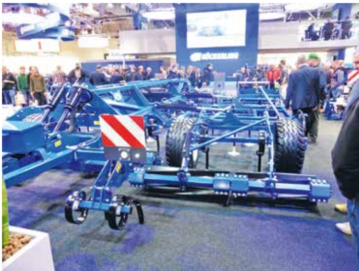
Mit dem Allrounder-flatline stellt Köckerling ein Gerät zur präzisen Bodenbearbeitung und die Einarbeitung von schwierigem organischem Material bei gleichzeitiger Konturanpassung an die zu bearbeitende Fläche vor.
