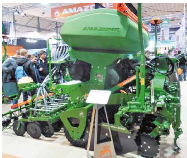
Amazone-Drillmaschinen können künftig – neben dem bewährten RoTeC-Schar – auch mit Doppelscheibenscharen ausgestattet werden.
