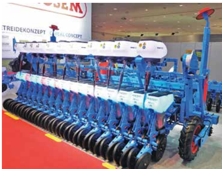
Die präzise Saatgutablage rückt auch beim Getreide, gerade bei der Verwendung von teurem Hybridsaatgut, immer weiter in den Fokus. Monosem präsentierte auf der Agritechnica eine Einzelkornsämaschine für Getreide, mit der Aussaatmengen von weniger als 100 Körner/m 2 möglich sind.
