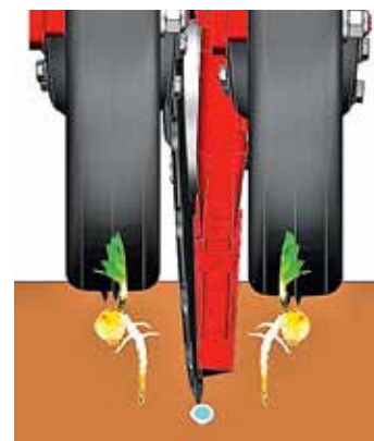
Mit dem Terrasem-Fertilizer-Pro-Schar trägt Pöttinger dem steigenden Trend zur Unterfußdüngung Rechnung. Das neue System legt ein Düngerdepot zum Korn beziehungsweise zur Wurzelbasis an.
