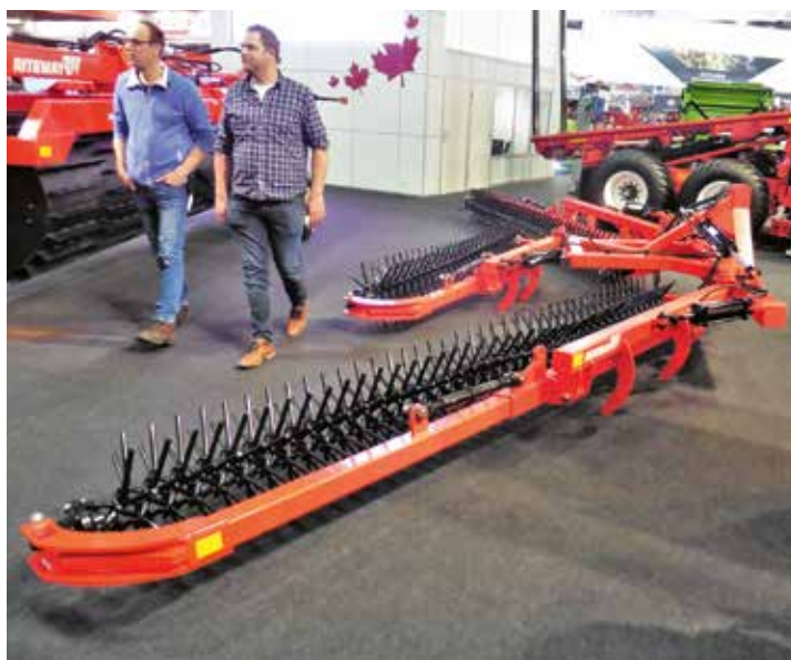
Kreiselegge auf kanadisch: Die Firma Riteway aus Regina, Saskatchewan, zeigte ein interessantes Gerät zur flachen Bodenbearbeitung und Strohzerkleinerung.
