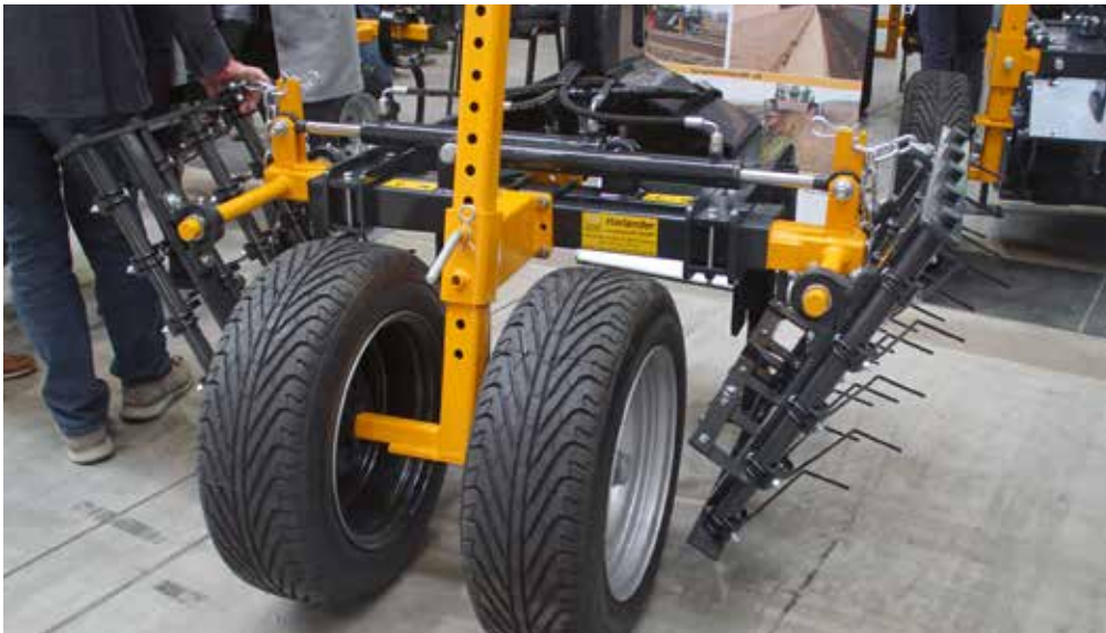
Der neue Spargeldammstriegel SDS-70 von Harlander Landtechnik wurde zur mechanischen Unkrautbekämpfung am seitlichen Spargeldamm entwickelt. Fotos: Brammert-Schröder
