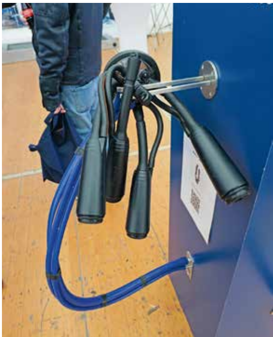
Mit dem De Laval Melkzeug Evanza soll durch neue Zitzengummis der Kuhkomfort beim Melken erhöht werden.
