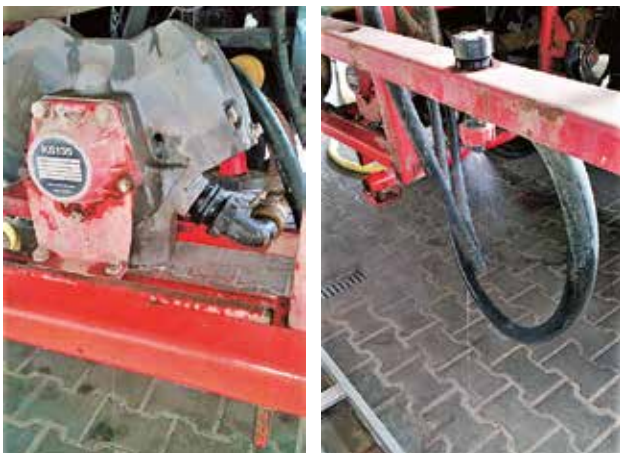
Undichte Pumpe (links) und Schlauch im Spritzstrahl.
